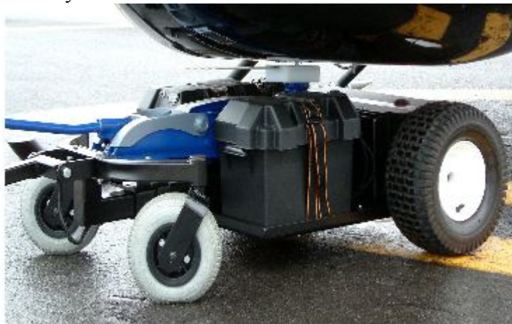
Obr. 10 Tow Carts V204 – 2 hnací kola, určeno pro Robinson R22,R44 [15]
