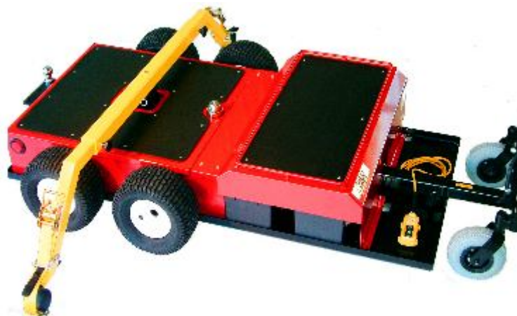
Obr. 11 Tow Carts V500 – 4 hnací kola, nosnost 7300kg [15]
