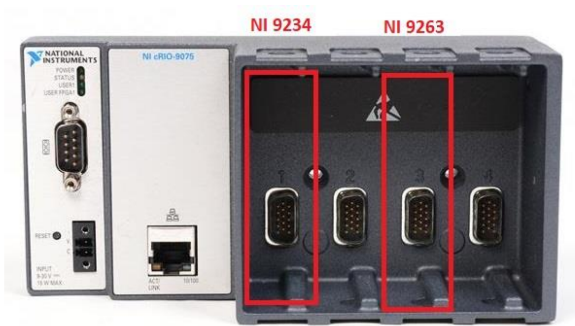
Obrázek 2 Umístění NI karet v cRIO 9076
