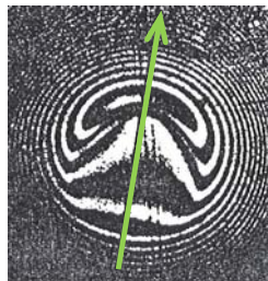
Obr. 2.28 Interferogram pro úhel mezi směry vektorů rychlostí 18^\circ [69].
