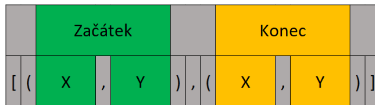
Obr. 3.5: Formát zprávy o provedeném tahu manipulátoru.
