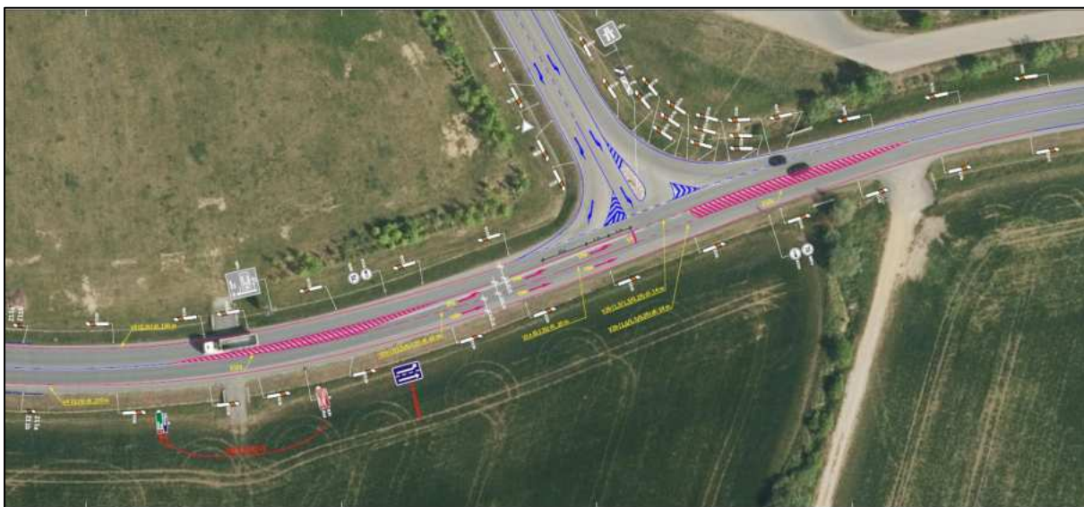
Obr. 58: Návrh úpravy stykové křižovatky [vlastní]
