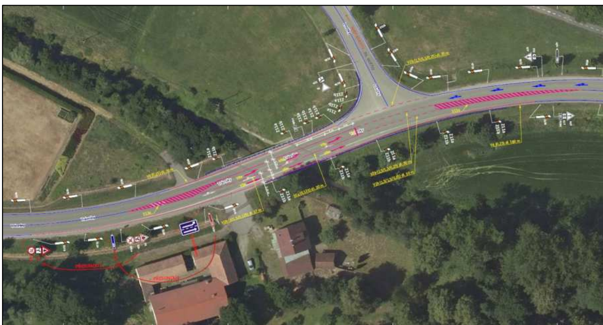
Obr. 62: Návrh úpravy stykové křižovatky [vlastní]
