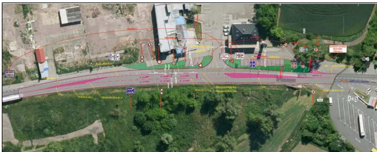
Obr. 66: Návrh úpravy stykové křižovatky [vlastní]
