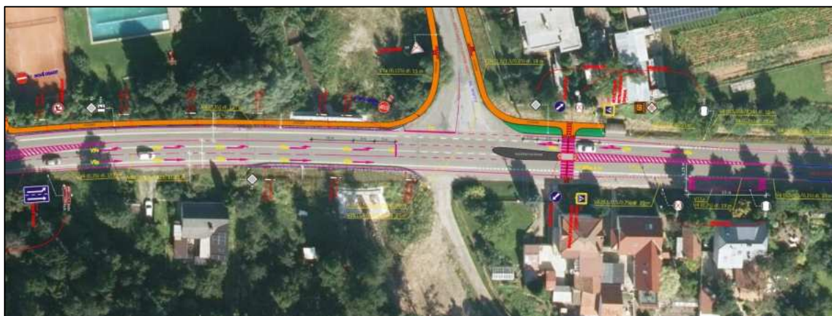
Obr. 50: Návrh úpravy stykové křižovatky [vlastní]
