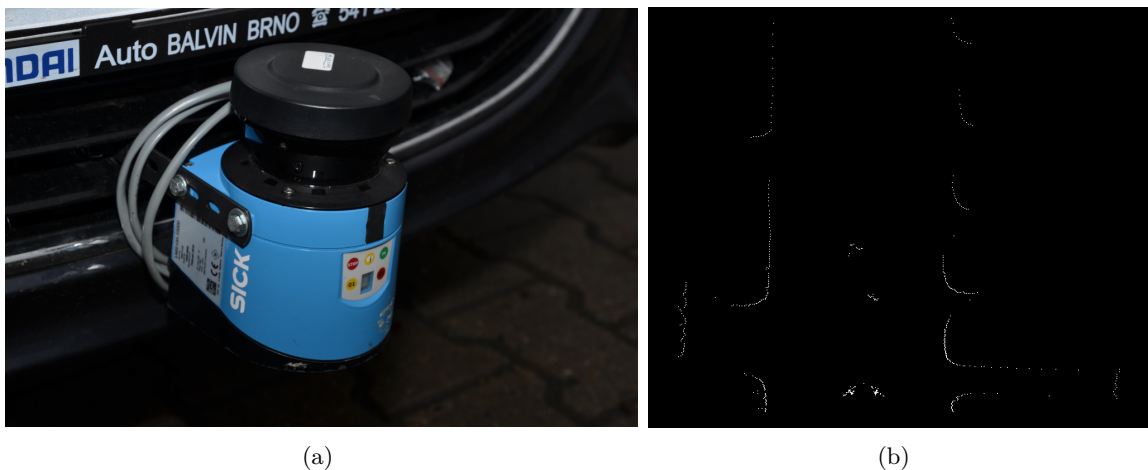
Obrázek 2.1: Ukázka 2D lidarů SICK LMS100 2.1(a) a vizualizace jeho scanu okolí 2.1(b) z projektu Roboauto 2014 1
