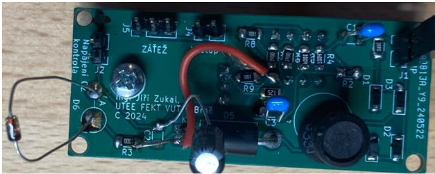
Obr. 77 Návrh DPS PFC obvodu: a) model KiCad; b) realizace a osazení horní strany.
