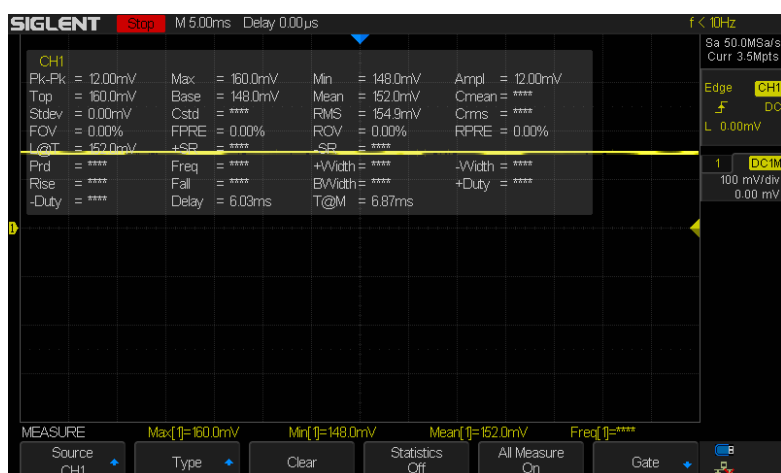
Obr. 59 Výstupní napětí generátoru s řazením segmentů do série a jedním usměrňovacím můstkem s využitím vyhlazovacího kondenzátoru C_v = 47 uF.
