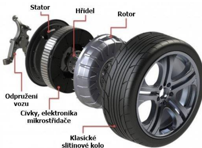
Obr. 30 Schéma motoru zabudovaného v kole[33]
