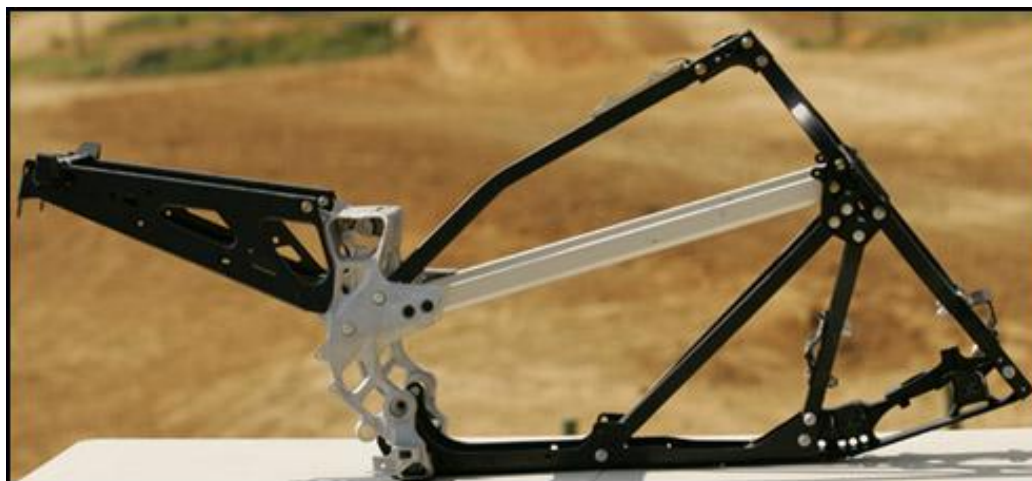
Obr. 23 Sestavený rám z hliníkové slitiny[27]
