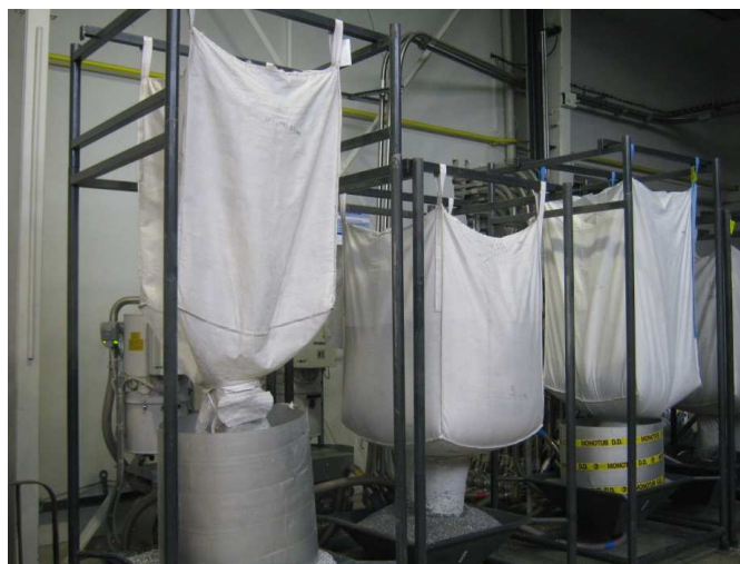
Obrázek 17: Vyprazdňování BB u centrálního zásobování
