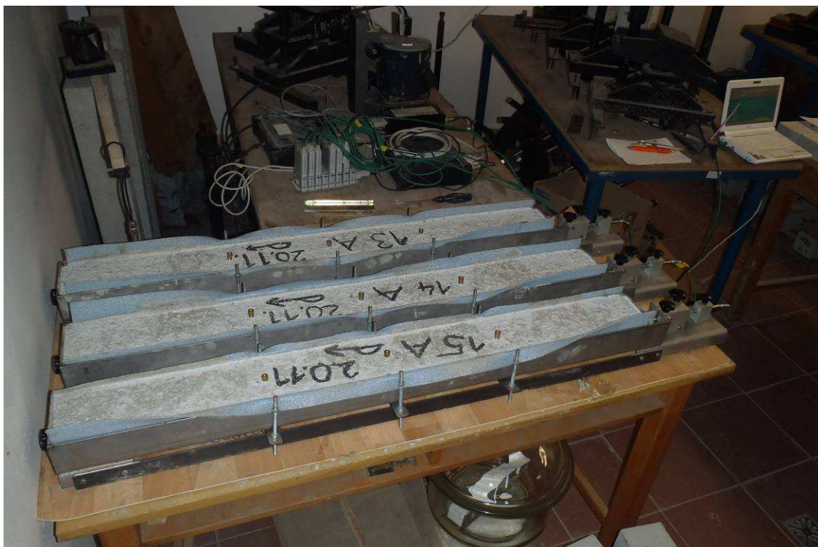
Obr. 8 Měření smrštění pomocí automatické záznamové jednotky
