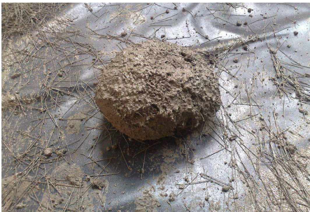
Obr. 1 Při nevhodném způsobu dávkování se mohou vytvořit tzv. ježci
