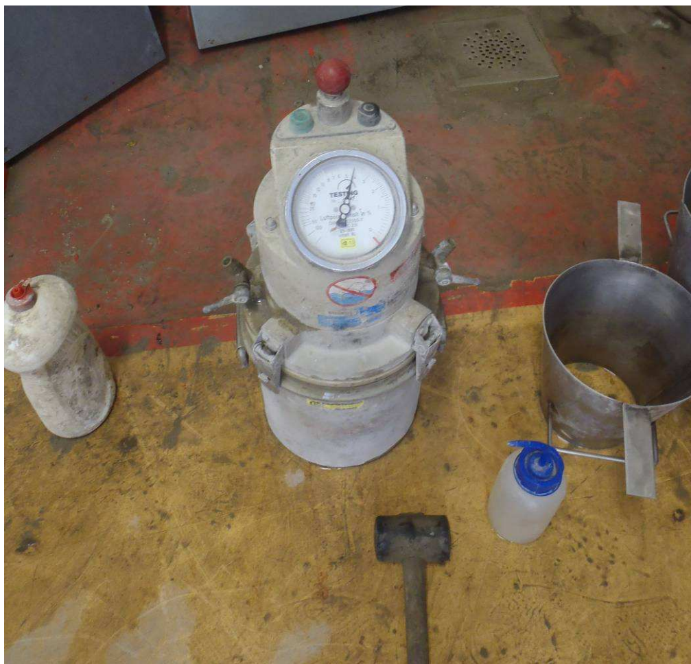
Obr. 5 Vyhodnocení zkoušky obsahu vzduchu
