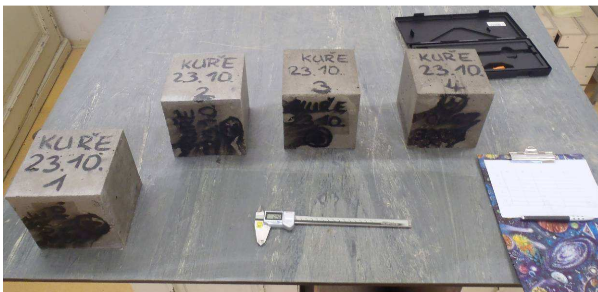
Obr. 9 Ověřování rozměrů zkušebních těles
