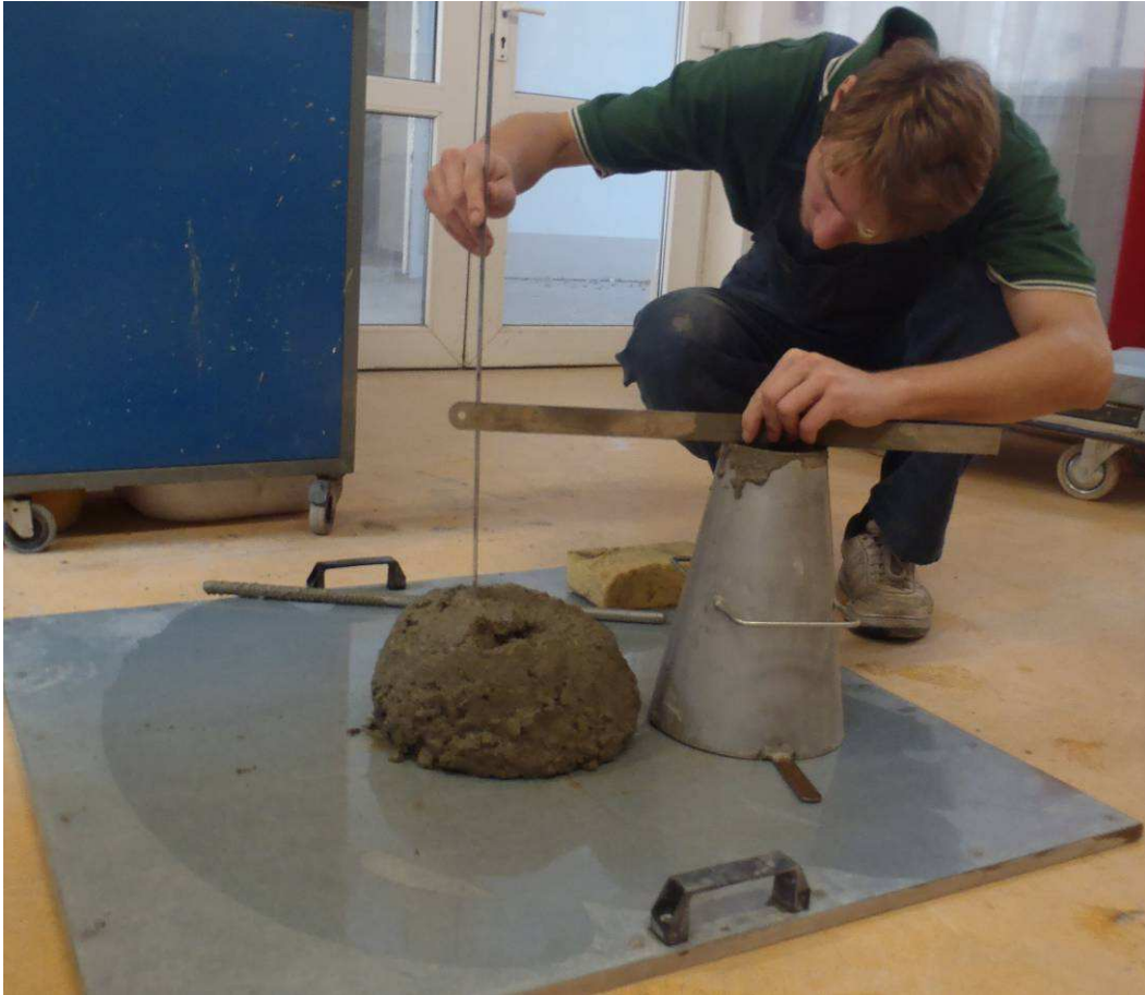
Obr. 3 Vyhodnocení zkoušky sednutí
