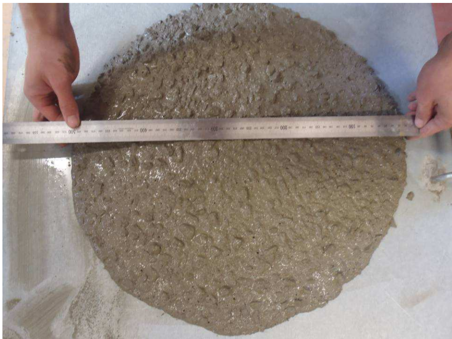
Obr. 4 Vyhodnocení zkoušky rozlitím
