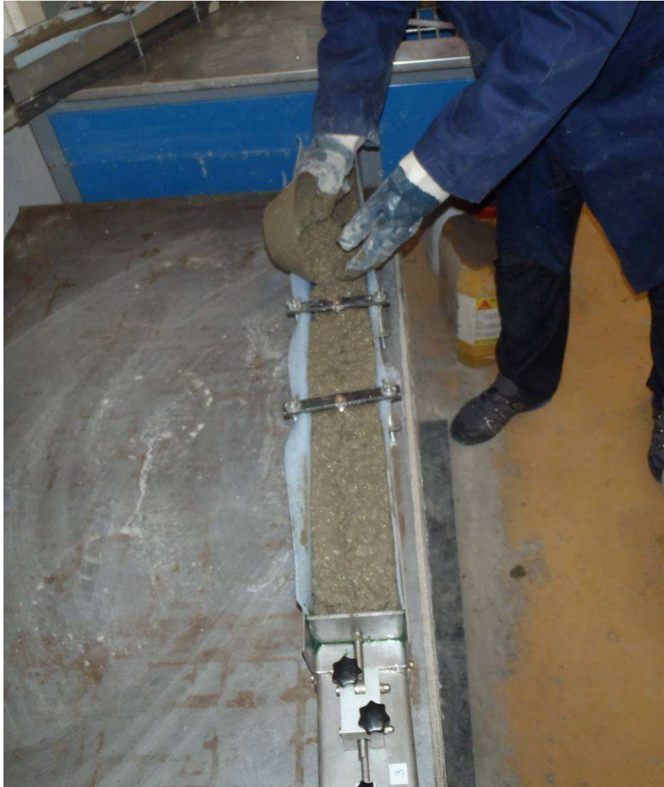
Obr. 6 Plnění forem pro měření smrštění
