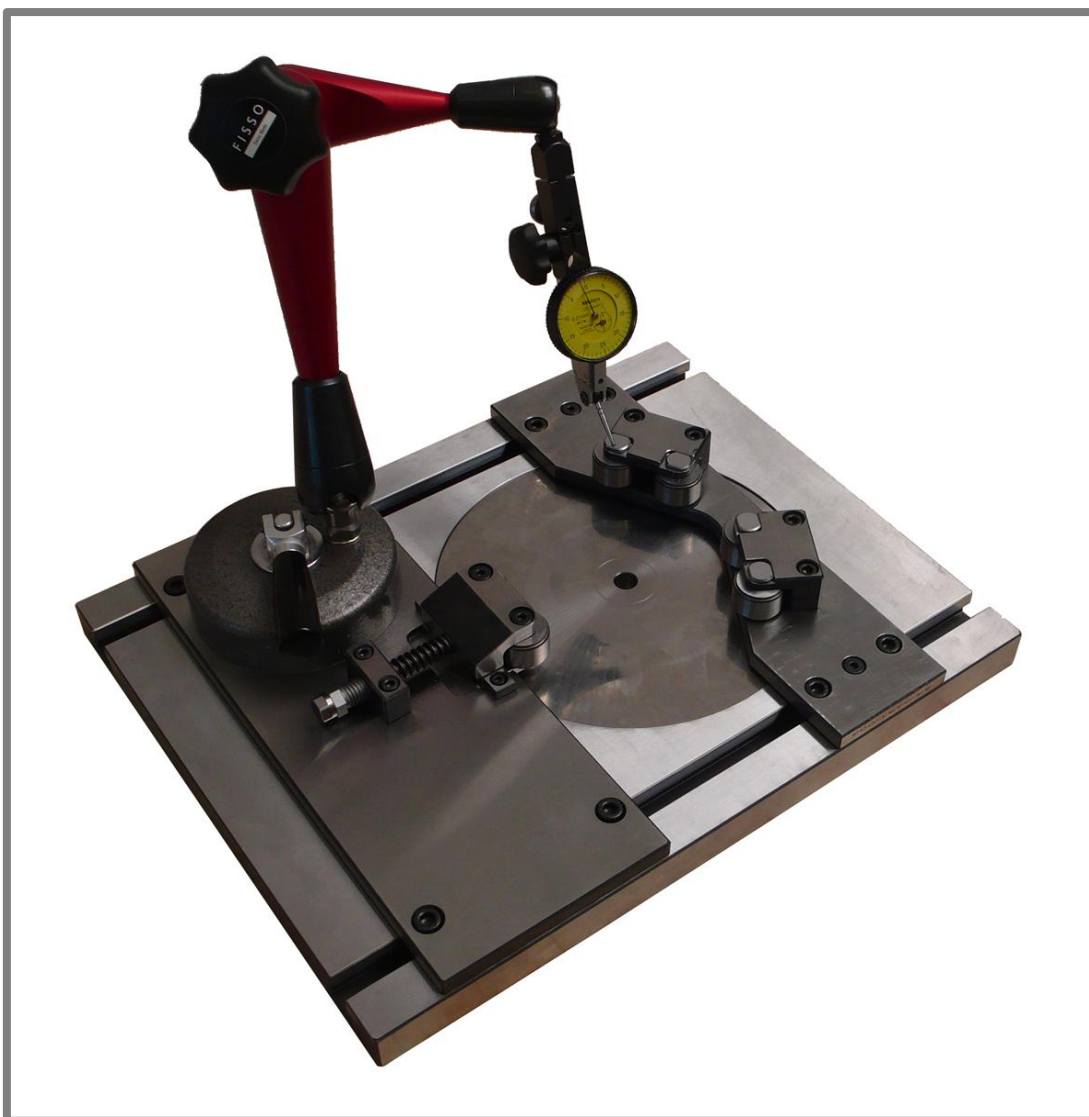
Obr. 5-17 Fotografie nového středícího přípravku s upnutým úchylkoměrem
