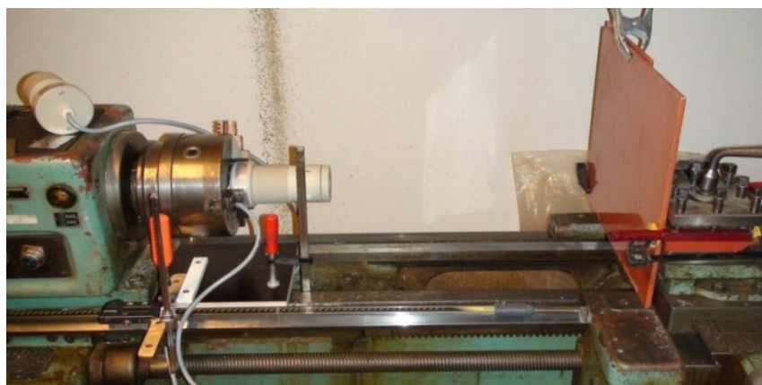
Obr. 6.4 Princip porovnávání měřených hodnot digitálního posuvného délkového měřidla a jednotlivých sond
