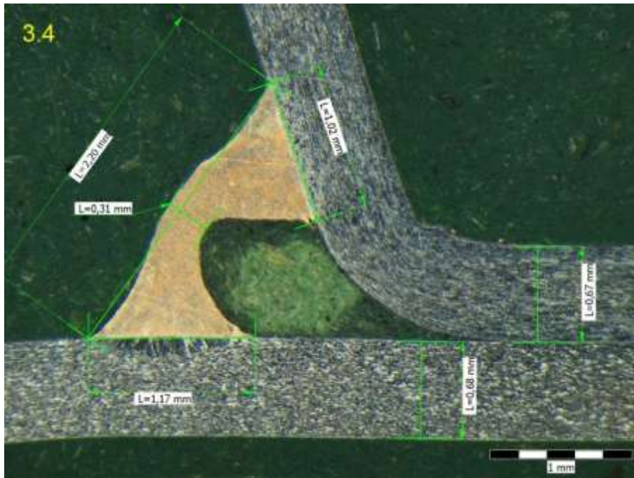
Příloha 35: 4. Víko, + 20% posuv drátu: metalografický výbrus, vzorek 3.4
