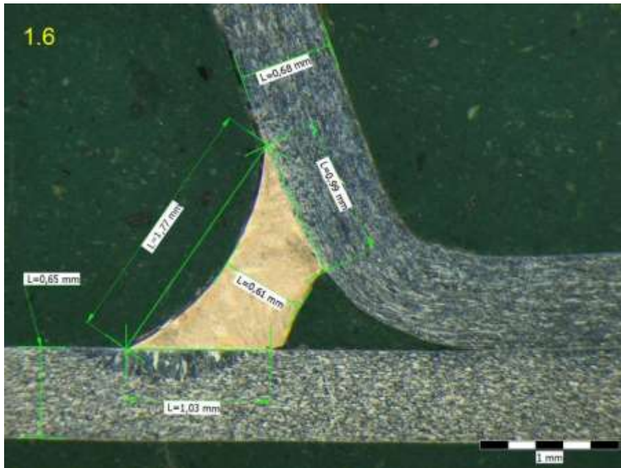
Příloha 45: 6. Víko, + 20% rychlost robota: metalografický výbrus, vzorek 1.6
