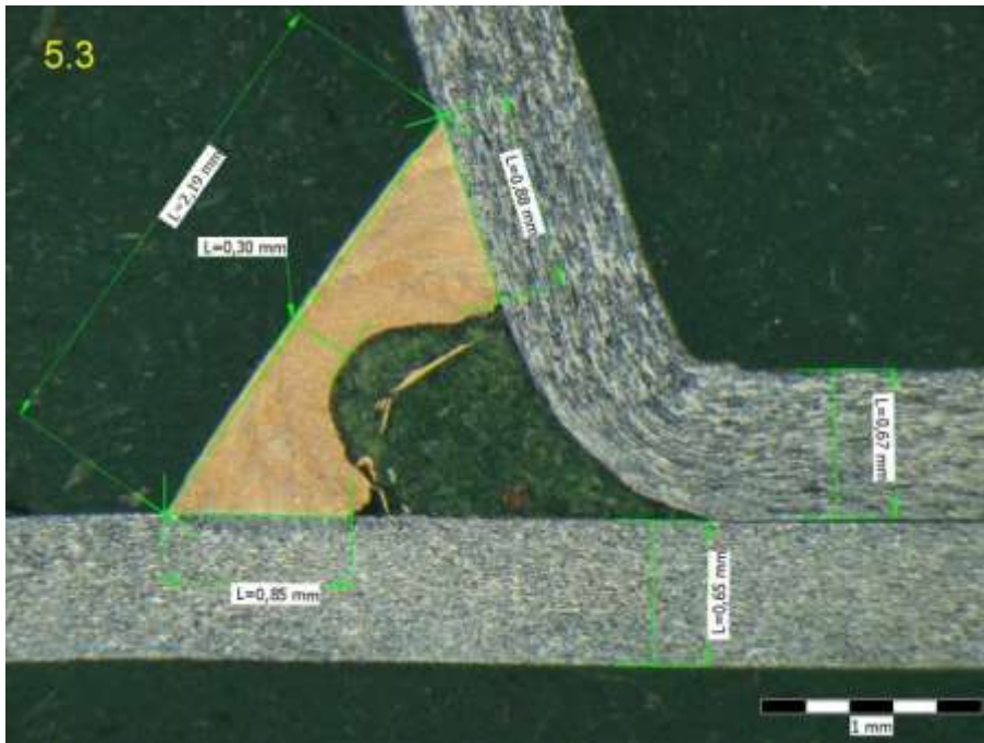
Příloha 31: 3. Víko, - 15% výkon: metalografický výbrus, vzorek 5.3
