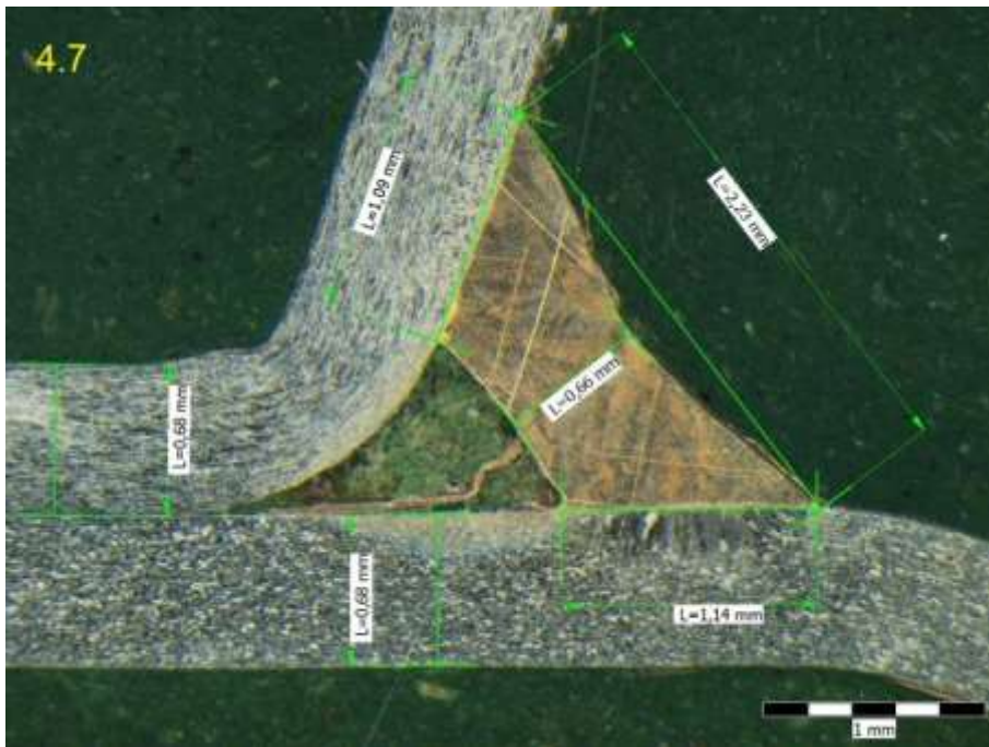
Příloha 54: 7. Víko, - 20% rychlost robota: metalografický výbrus, vzorek 4.7
