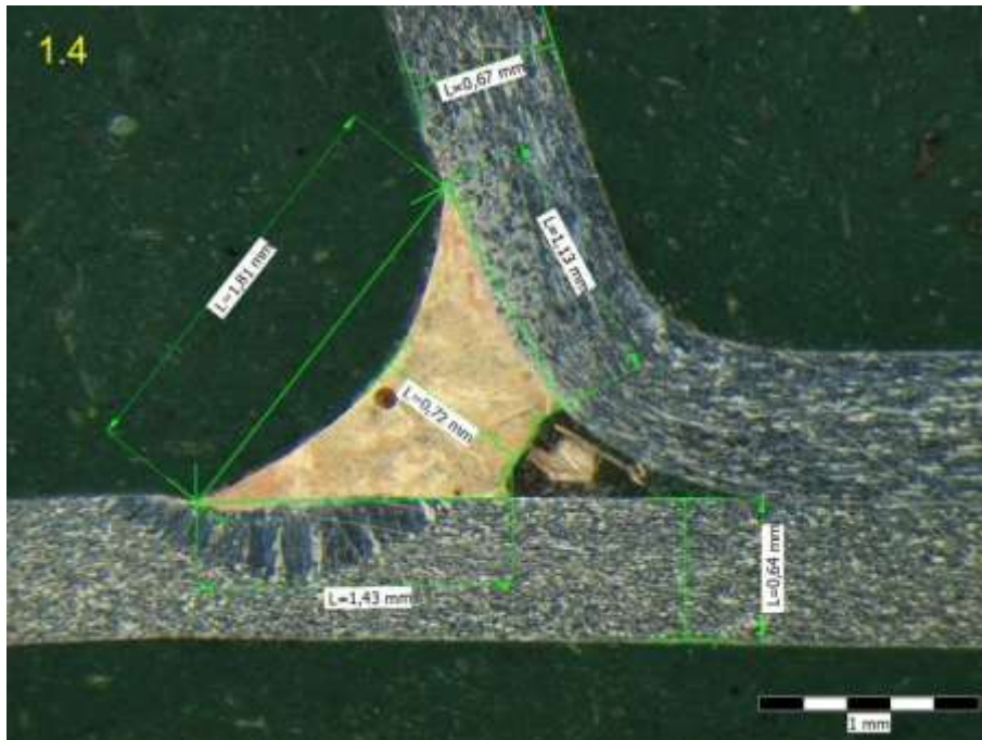
Příloha 33: 4. Víko, + 20% posuv drátu: metalografický výbrus, vzorek 1.4
