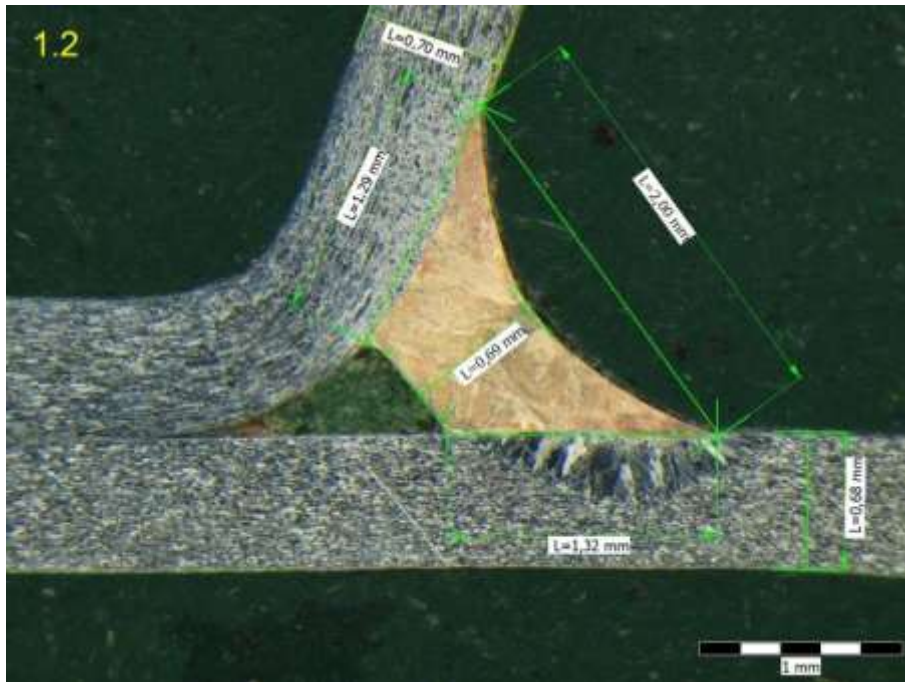
Příloha 21: 2. Víko, + 15% výkon: metalografický výbrus, vzorek 1.2
