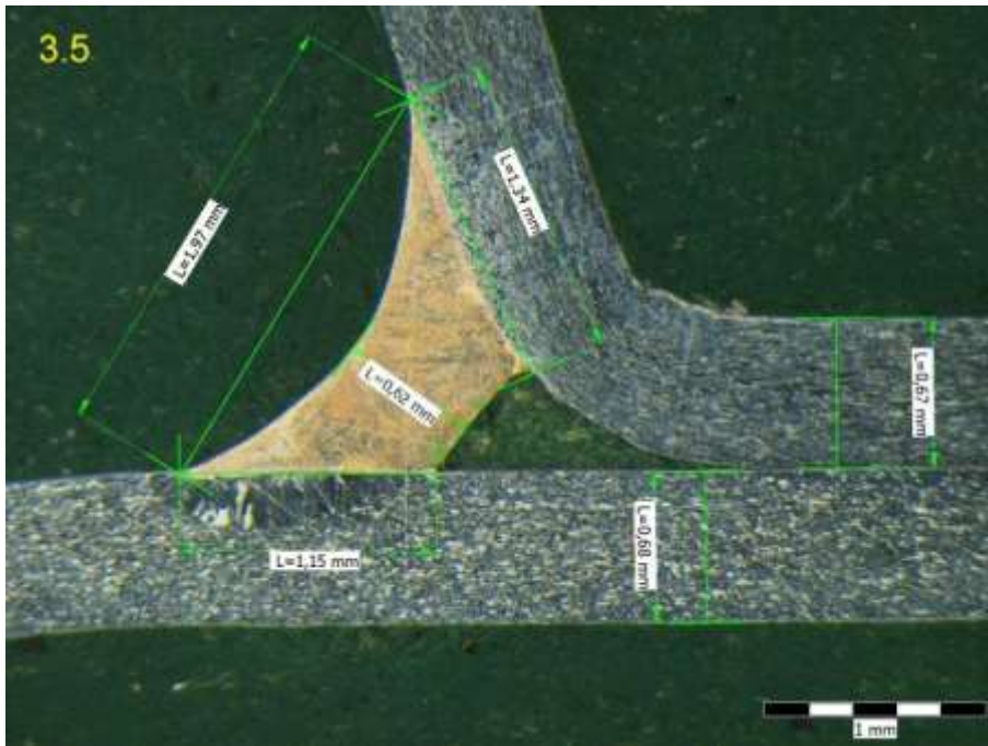
Příloha 41: 5. Víko, - 20% posuv drátu: metalografický výbrus, vzorek 3.5
