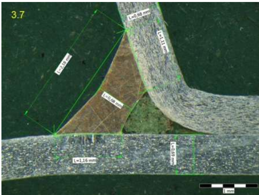
Příloha 53: 7. Víko, - 20% rychlost robota: metalografický výbrus, vzorek 3.7
