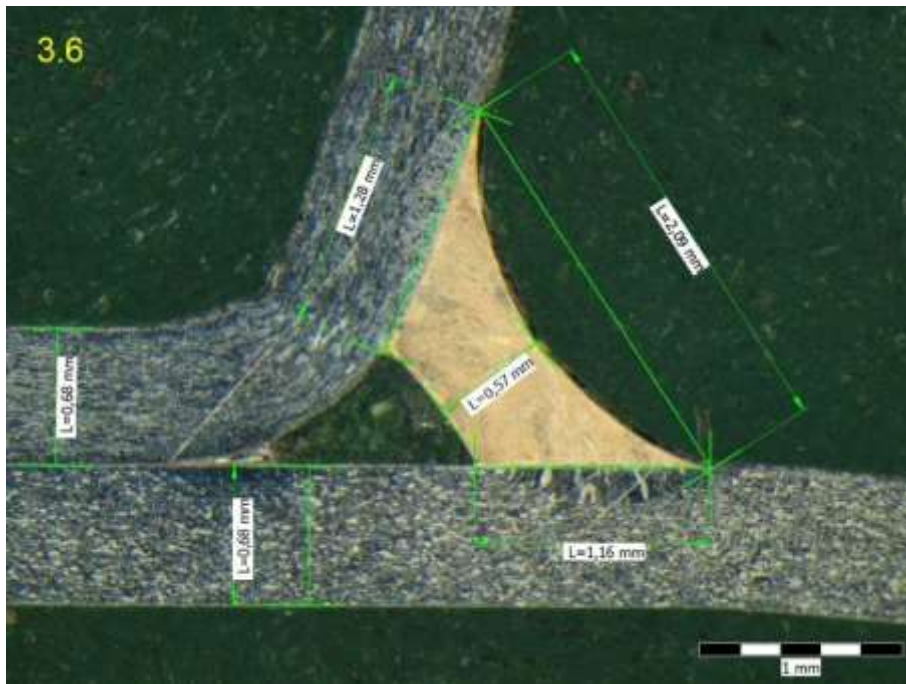
Příloha 47: 6. Víko, + 20% rychlost robota: metalografický výbrus, vzorek 3.6
