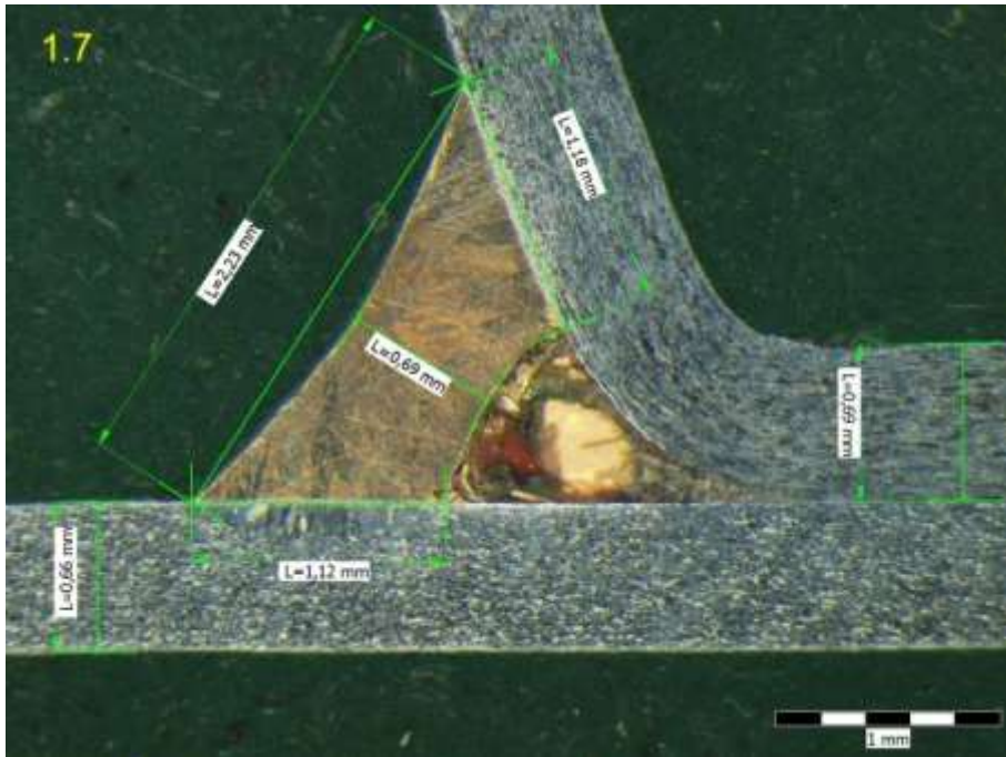
Příloha 51: 7. Víko, - 20% rychlost robota: metalografický výbrus, vzorek 1.7
