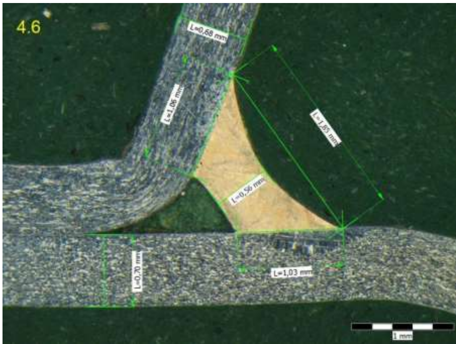
Příloha 48: 6. Víko, + 20% rychlost robota: metalografický výbrus, vzorek 4.6
