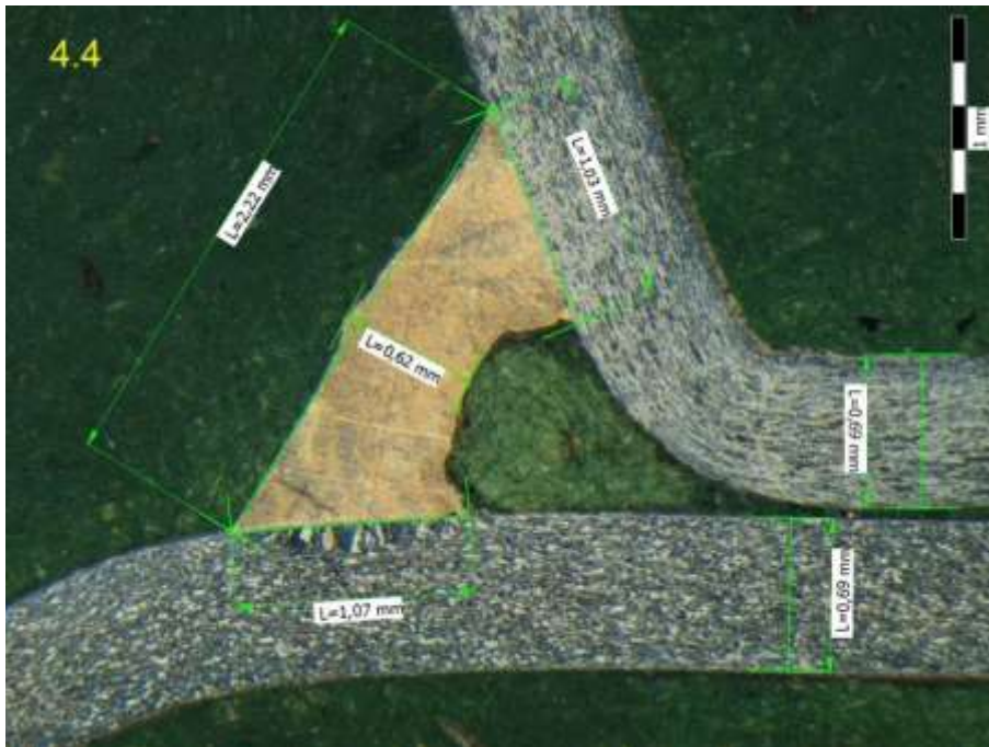
Příloha 36: 4. Víko, + 20% posuv drátu: metalografický výbrus, vzorek 4.4
