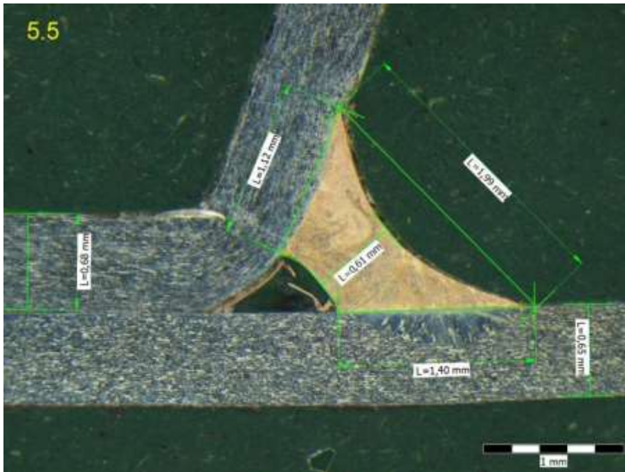
Příloha 43: 5. Víko, - 20% posuv drátu: metalografický výbrus, vzorek 5.5
