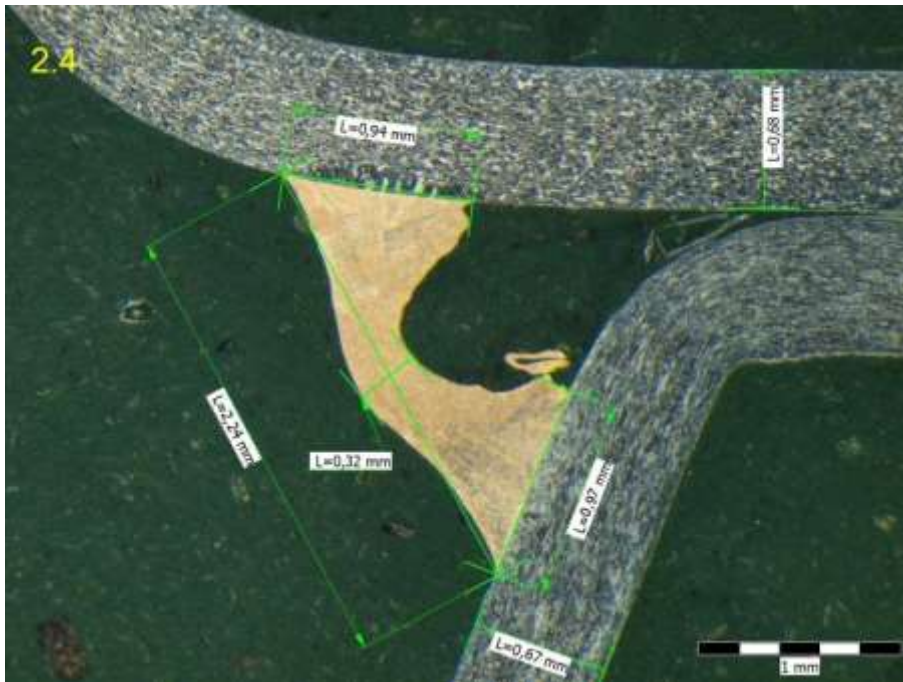
Příloha 34: 4. Víko, + 20% posuv drátu: metalografický výbrus, vzorek 2.4
