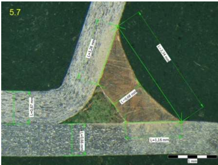
Příloha 55: 7. Víko, - 20% rychlost robota: metalografický výbrus, vzorek 5.7
