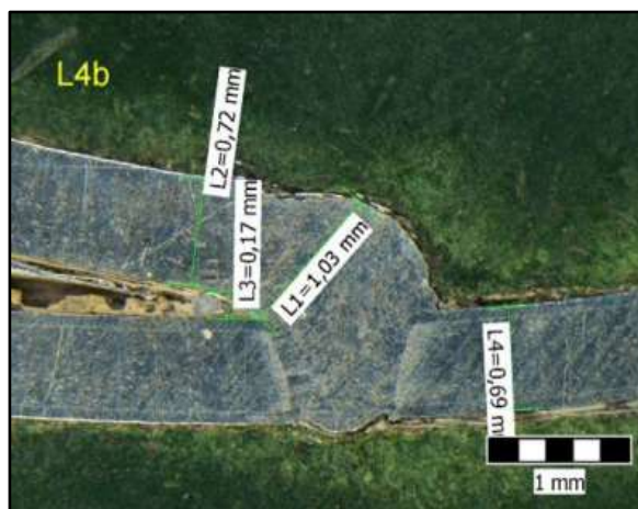
Obr. 19 Příklad metalografických výbrusů laser svaru [39]
