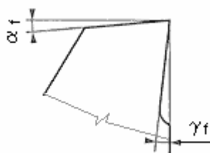
Obr. 3.2 Geometrie zubu frézy.
