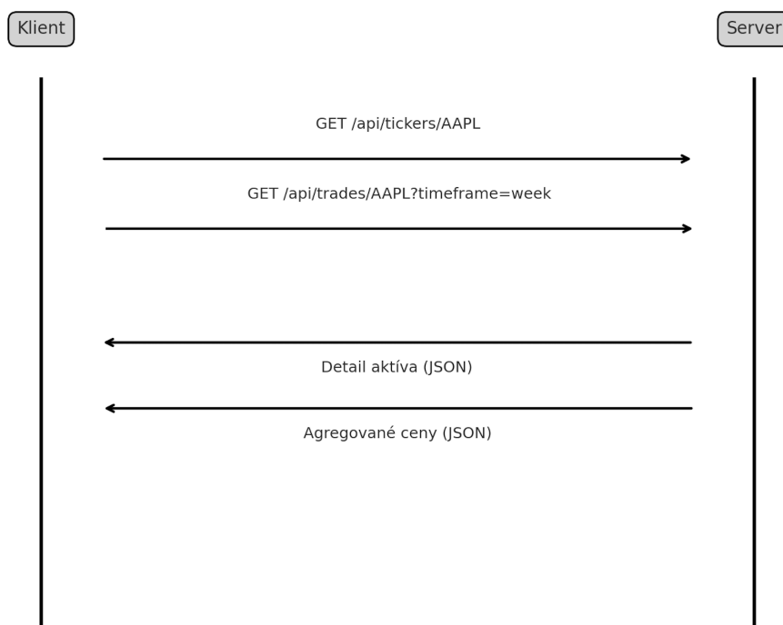
Obr. 3.3: Príklad komunikácie klienta so serverom pri načítaní obrazovky detailu aktíva.
