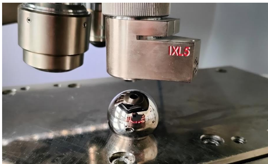
Obr. 4-3 Detail při měření drsnosti povrchu
