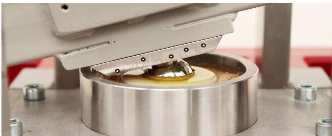
Obr. 4-5 Detail materiálové dvojice v simulátoru [29]
