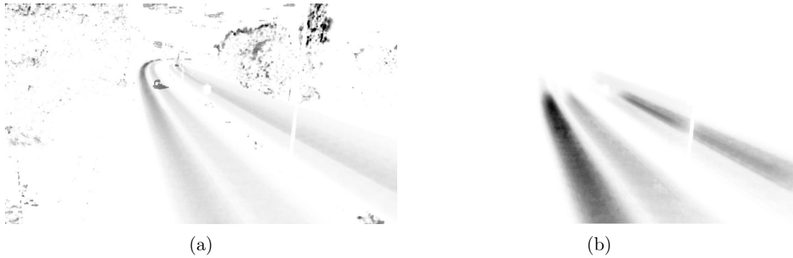
Obrázek 4.12: Výsledný integrální obraz. (a) před filtrováním a (b) po filtrování pouze blobů označených jako vozidlo.
