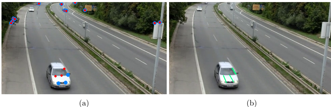
Obrázek 4.1: Zobrazení příznakových bodů, červeně minulý snímek, modře aktuální snímek (a) a vybrané dvojice pro akumulaci (b).
