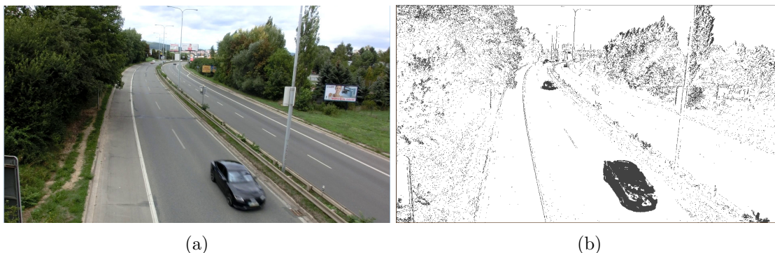
Obrázek 4.5: Jeden z původních obrázků (a) a výsledný obrázek metody odečtu pozadí (b).
