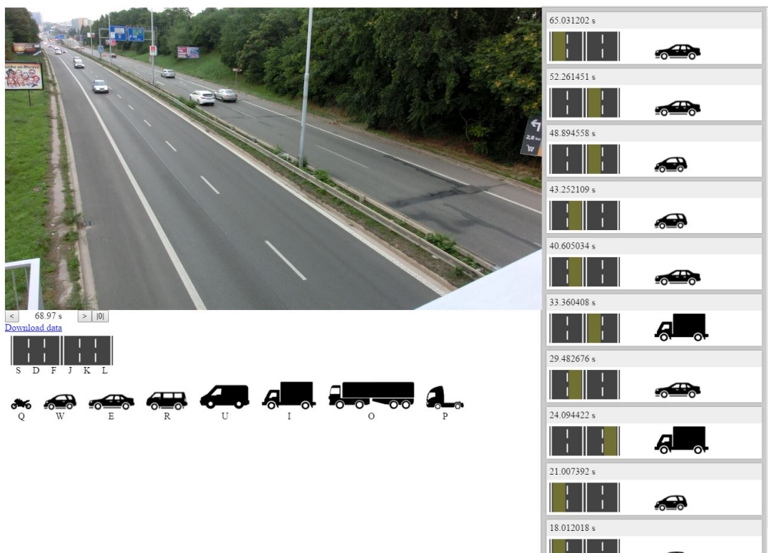
Obrázek 6.1: Aplikace pro anotaci videa. V levé horní polovině je přehrávané video, v levé dolní polovině pak ovládací prvky s přiřazenými klávesami a v pravé části pak seznam posledních anotovaných vozidel.
