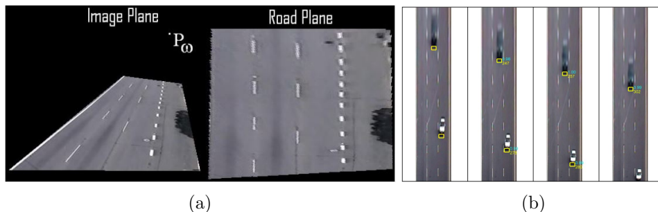
Obrázek 2.9: Warpování obrazu (a) a měření vzdálenosti na po sobě jdoucích snímcích (b). Převzato z [18] a [11].
