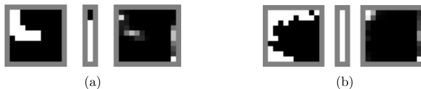
Obrázek 4.7: Histogram kanálů HS, kanálu V a výsledný spojený a normalizovaný histogram pro tmavé vozidlo (a) a pro světlé vozidlo (b).
