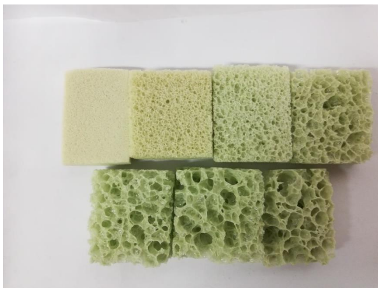
Obrázek 28: Vzorky připravených pěnových skel s dobou pění 0–60 min.
