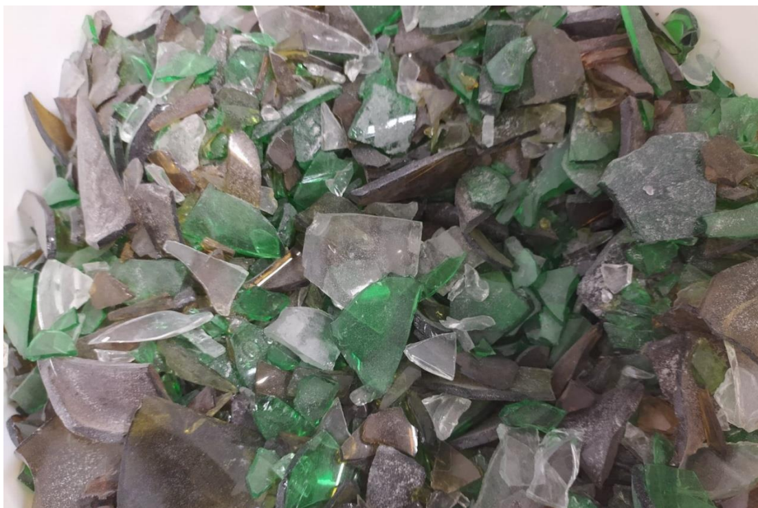
Obrázek 8: Střepy odpadního obalového skla, použitého pro výrobu pěnového skla
