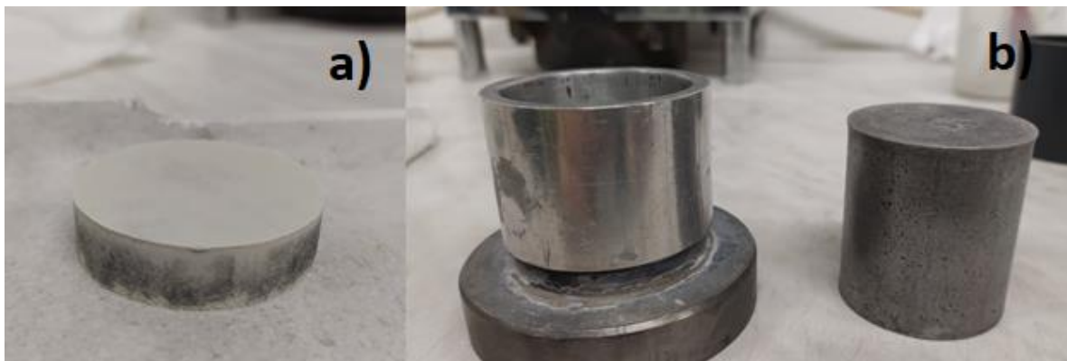
Obrázek 9: Vylisovaná tableta před výpalem (a), forma použitá k lisování tablet (b)
