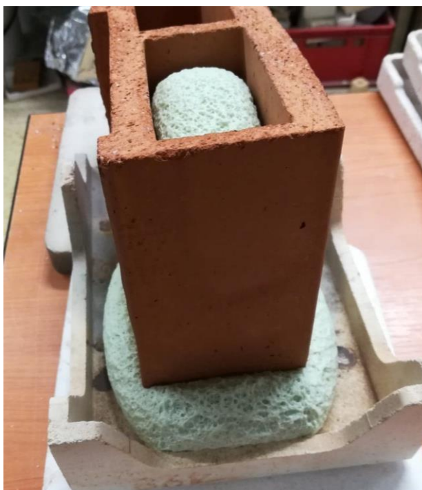
Obrázek 35: Vyplněná cihla pálená ve vertikální poloze
