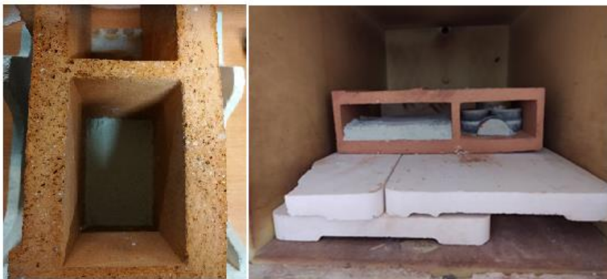
Obrázek 14: Testované způsoby vyplnění cihel při a) vertikální poloze, b) horizontální poloze cihly při výpalu
