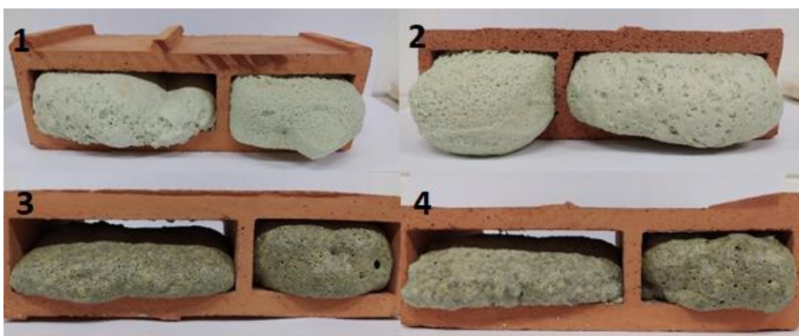
Obrázek 36: Vyrobene části plněných cihel při horizontálním uložení
