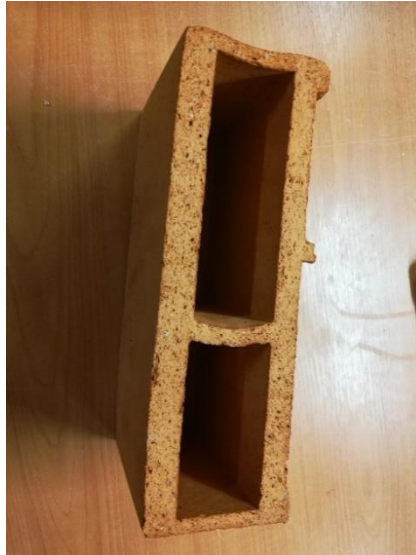
Obrázek 13: Část cihly využitá ke zkouškám plnění cihel pěnovým sklem
