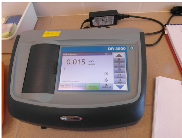
Obrázek 14: Spektrofotometr HACH LANGE DR3900[foto: Milan Herka]
