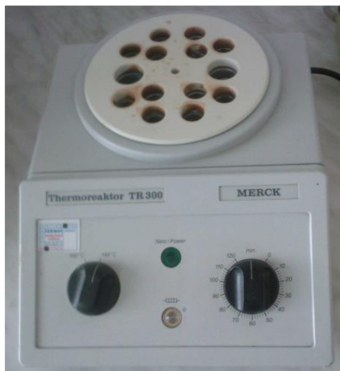
Obrázek 18: Termoreaktor Merck TR 300 [foto: Milan Herka]
