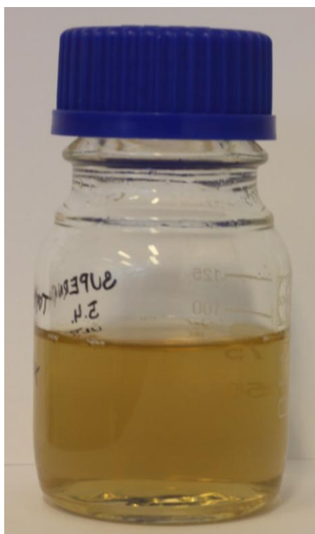
Obrázek 17. Supernatant získaný postupem 2 – mechanické namáhání dispergátorem Ultra-Turrax Tube Drive, bez následné oxidace peroxidem vodíku
