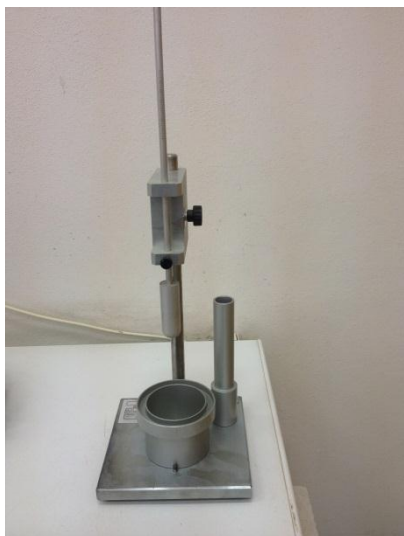
Obr. 7: Přístroj pro stanovení hodnoty penetrace
