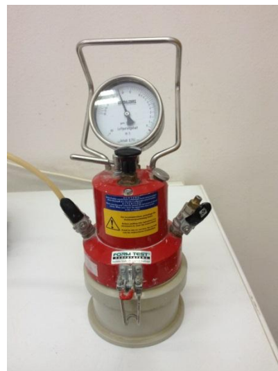
Obr. 8: Přístroj pro stanovení obsahu vzduchu
