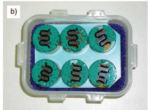
Obr. 37 Příprava vzorků a) série 2h a 5h vyjmutá z trubiček, b) všechny série zalisované do směsi Isofast + Dentacryl.
