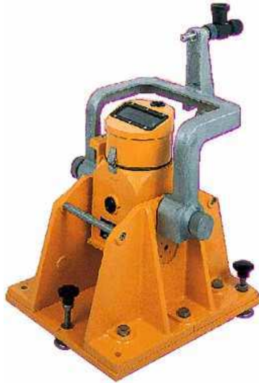
Obr. 4.4 - Sky-screen hradlo fy HPI (převzato z [7])
