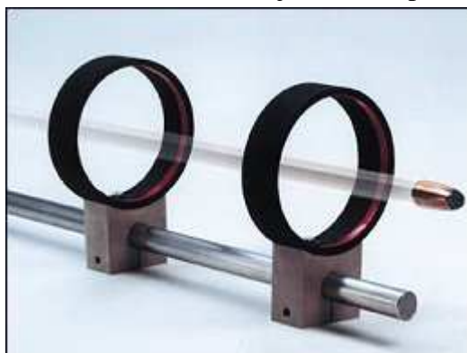
Obr. 4.7 - Elektromagnetické hradlo fy Kaman (převzato z [9])
