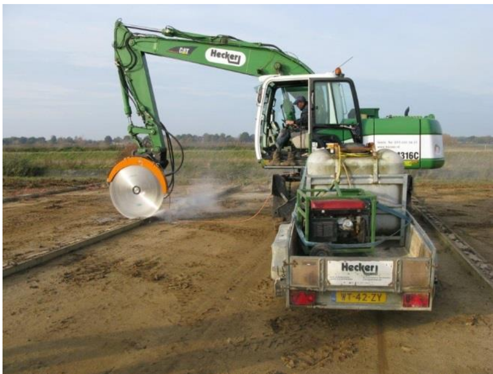
Obr. 3 Kotoučová pila vybavena elektrohydraulickým PID [OBR3]
