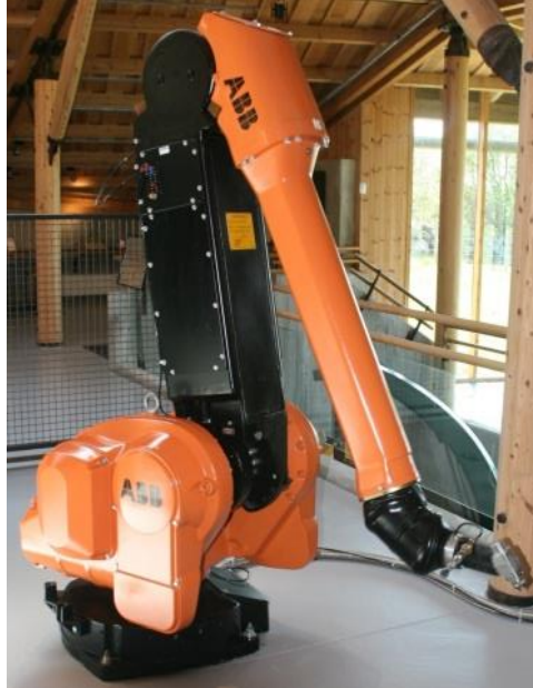
Obr. 9 Průmyslový 3-osý robot ABB doplněný 3-osým koncovým orientačním ústrojím [OBR9]
