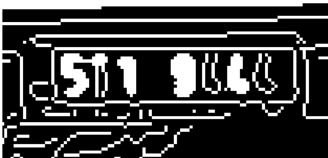
Obrázek 29 Problém nezobrazení kompletní hrany a následné nevyplnění oblasti
