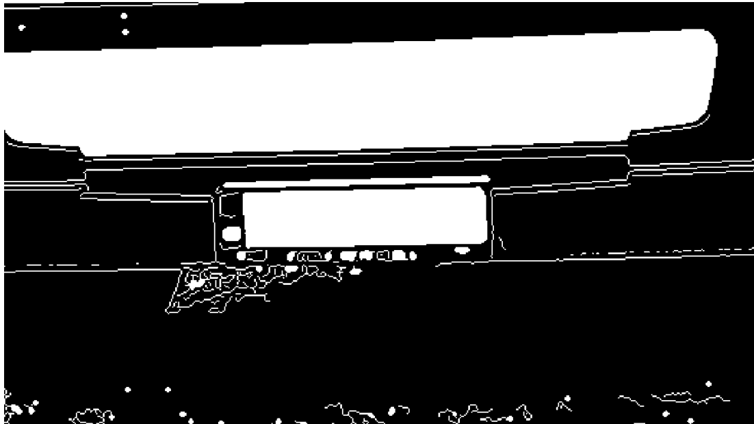
Obrázek 30 Úspěšné zobrazení hrany registrační značky a následné vyplnění oblasti
