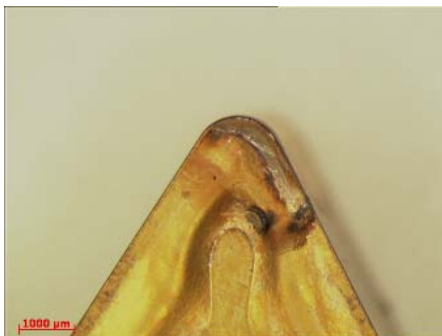
Destička 2015 doba řezu 2 min s chlazením
