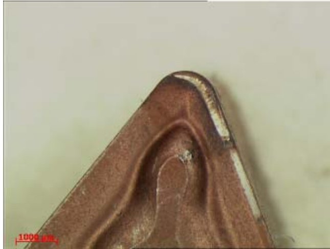
Destička 1115 doba řezu 2 min, posuv 0,18mm, s chlazením
