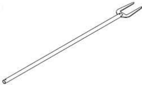
Pracovní vidlice pro osazování a odnámání nosníků
