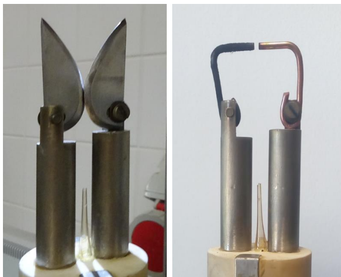
Obrázok 14: Elektródové usporiadanie pre kĺzavý oblúkový výboj (vľavo) a tlecí výboj (vpravo)
