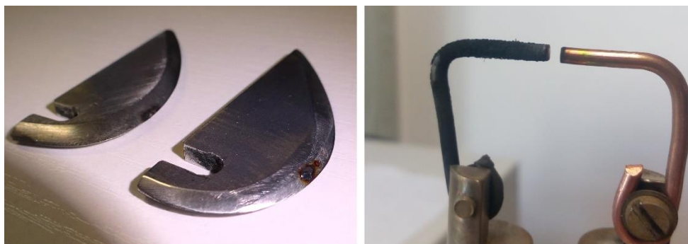
Obrázok 20: Vznikajúca uhl'ovodíková sadza v experimentoch s plynou zmesou N_2-CH_4 : nerezové elektródy pre GAD (vľavo), medené elektródy pre tlecí výboj (vpravo)
