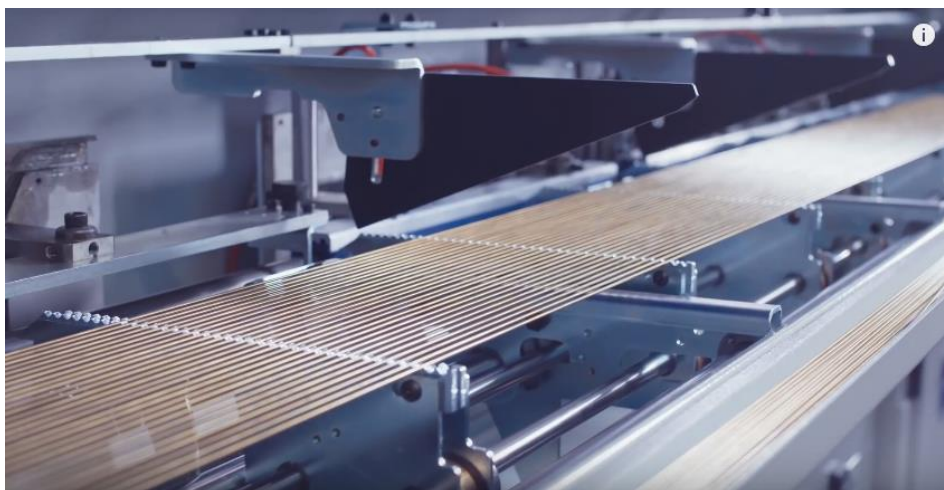
Obr. 10 Hřebenové podávání tyčí (Převzato: http://www.iemca.com/Elite220_scheda_prodotto.html#top )
