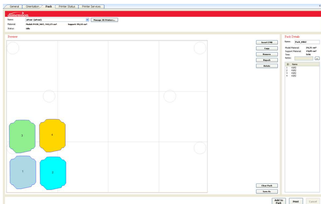
Obr. 3. 13 Ustavení součástí na nosné desce [15].
