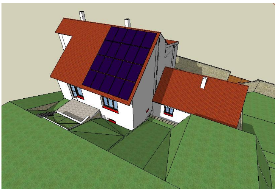
Obr. č. 19 Umístění fotovoltaických panelů na střeše
