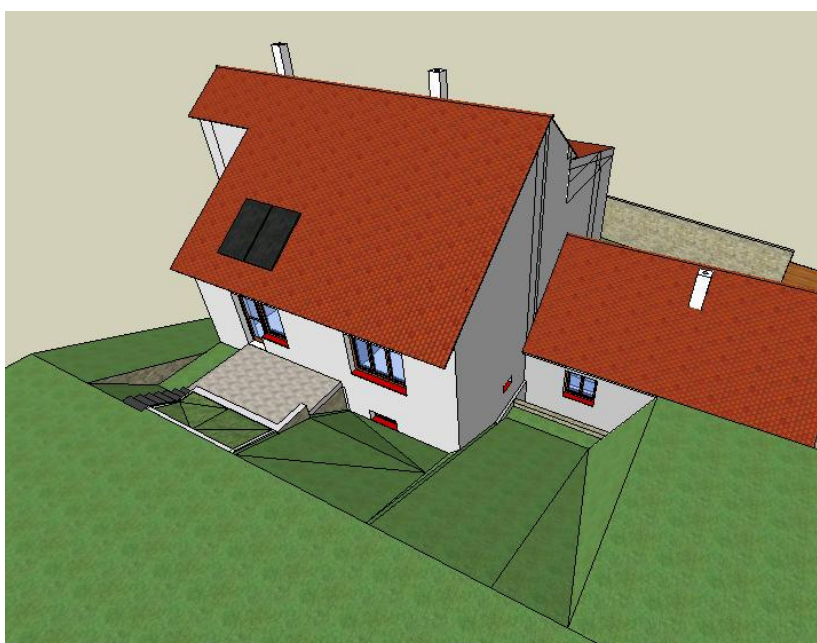
Obr. č. 18 Umístění solárních panelů na střeše
