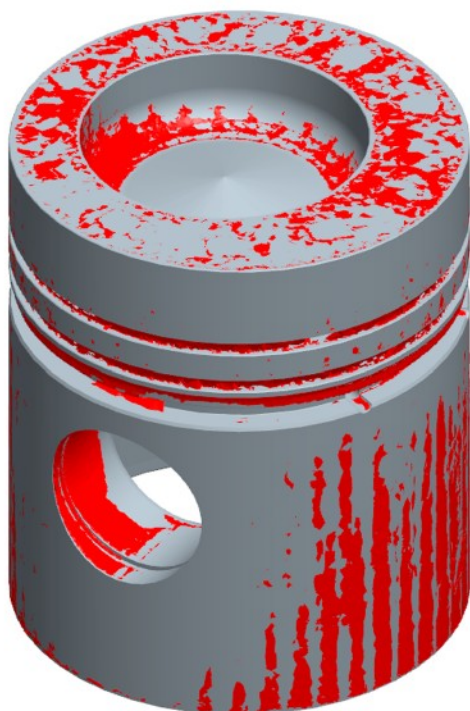
Obr. 41 Srovnání CAD modelu s naskenovanými daty
