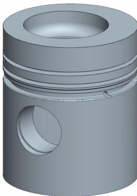
Obr. 39 Konečná podoba CAD modelu pístu
