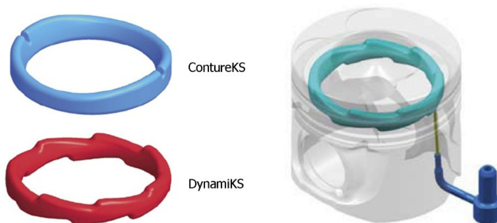
Obr. 14 Variabilní průřezy chladících kanálů [13], [17]
