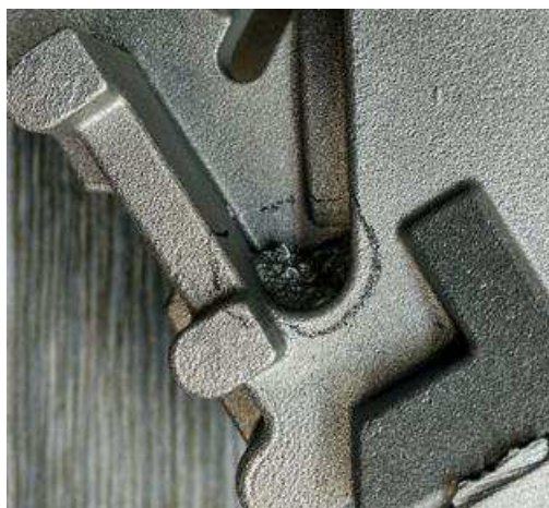
Obr. 21 – Výronek v koutu odlitku
