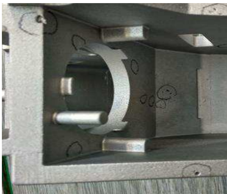
Obr. 37 – Odlitek s viditelnými bublinami
