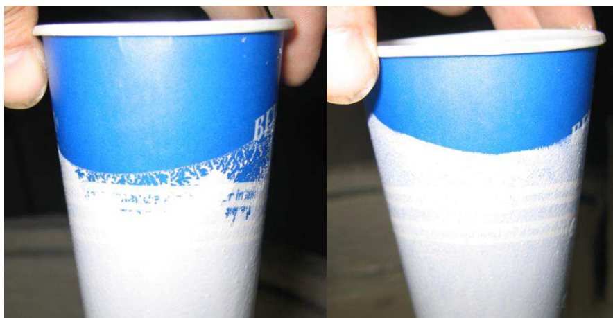
Obr. 16 – Wetting test – a) špatné pokrytí, b) dobré pokrytí [32]
