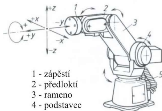
Obr. 6 Schéma s vyznačeným systémem souřadnic os otáčení a posuvů [15].
