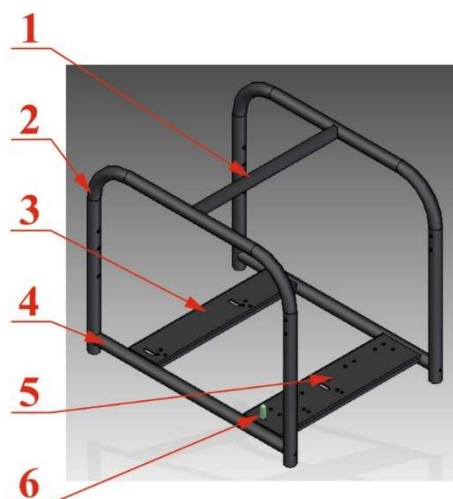
Obr. 16 Sestava rámu elektrocentrály.
