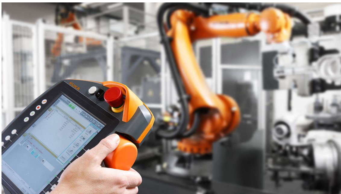
Obr. 8 Programování robota pomocí ovládací konzole [19].
