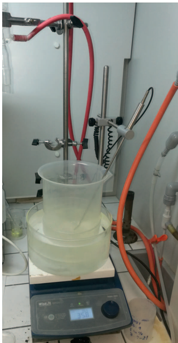
Obr. 29: Příprava simulované tělesné tekutiny pro biodegradční testy 3D těles z PHB/PLA/TCP/HA biokompozitu.
