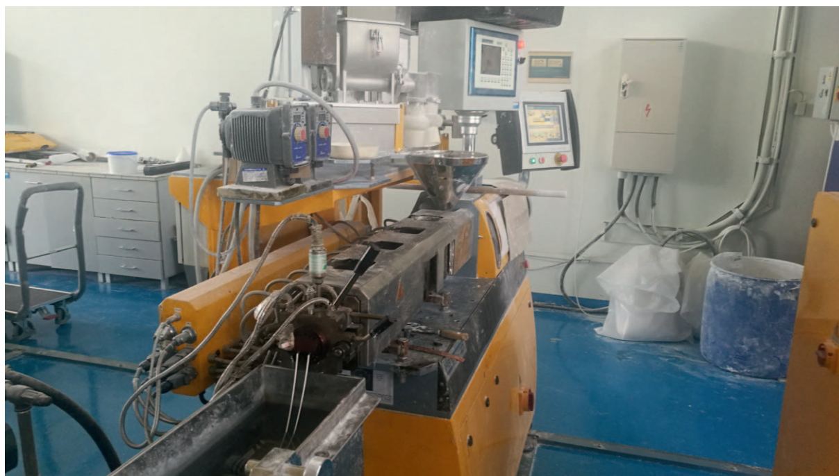
Obr. 13: Dvoušnekový extrudér značky Labtech Engineering Company LTD.
