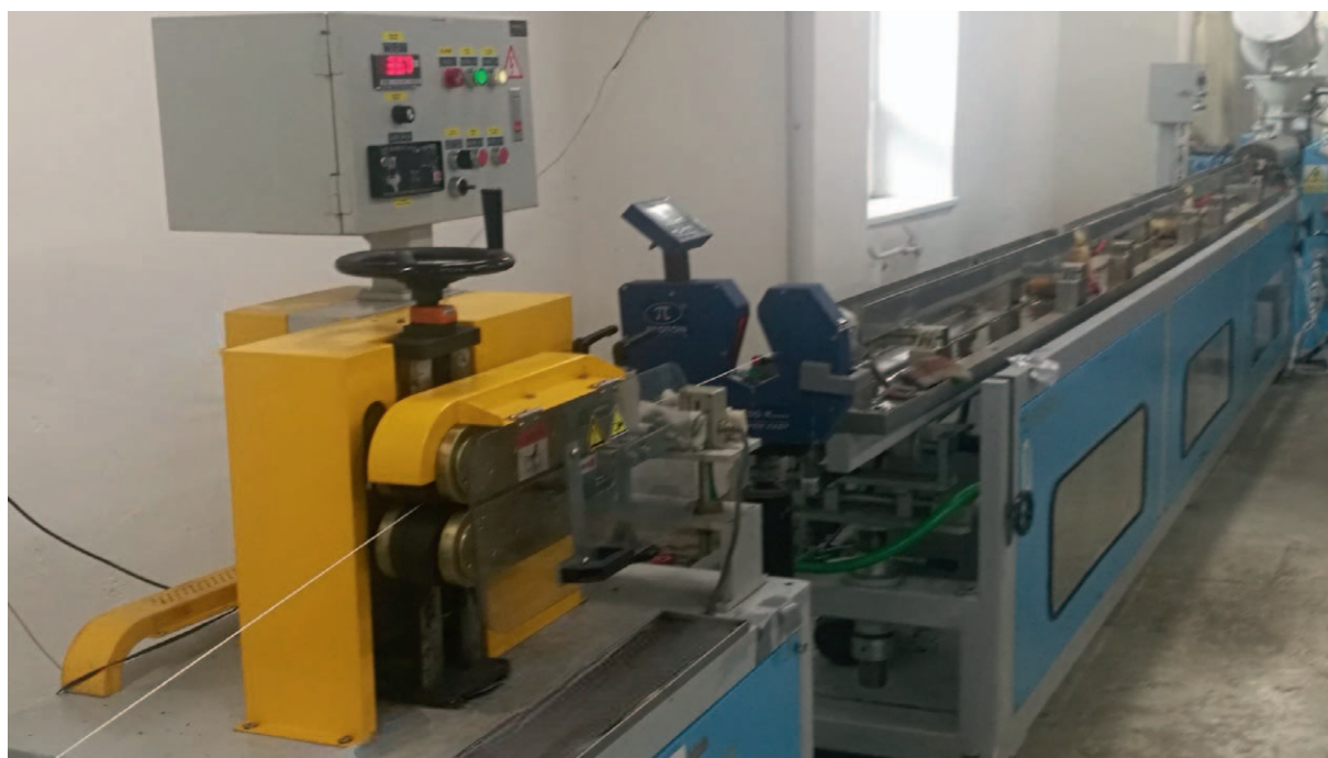
Obr. 14: Jednošnekový extrudér značky Everplast Machinery Co., LTD.
