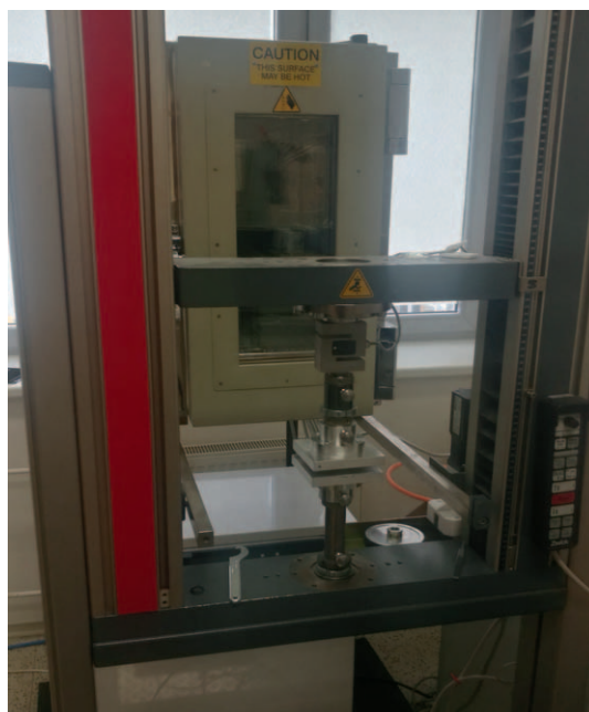
Obr. 27: Mechanické testování standardizovaných tlakových těles na přístroji Zwick Roell Z010.
