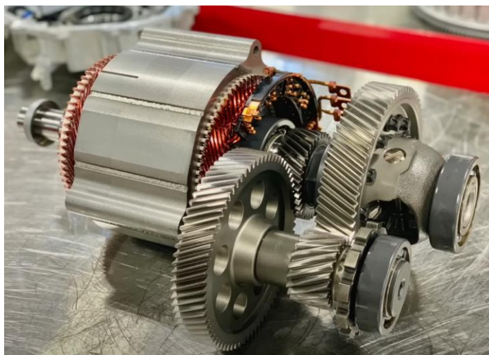
Obrázok 33: Kompletná zostava rotujúcich častí Chevrolet Bolt EV [14].
