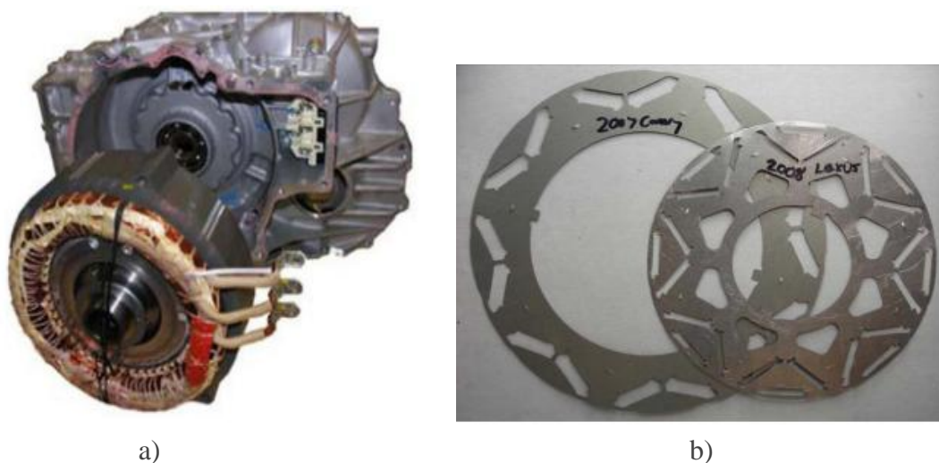
Obrázok 31: a ) Elektromotor Camry 2007 [17] b) rotorové plechy Camry a lexus [10].
