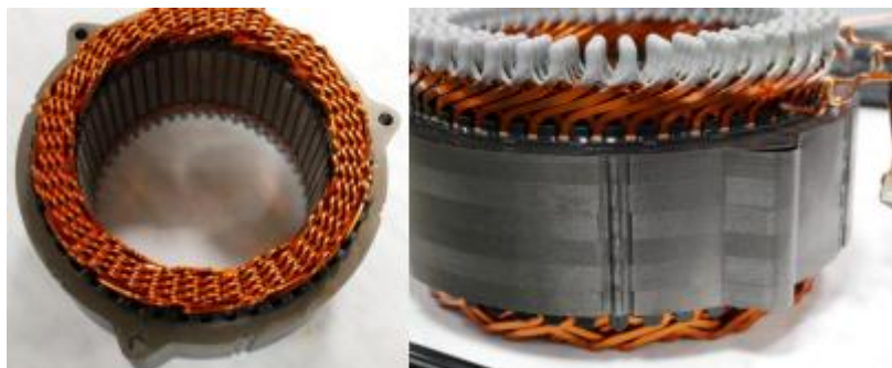
Obrázok 23: Vlásokovité vinutie statora [9]
