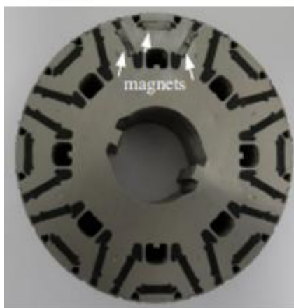
Obrázok 24: Spôsob uloženia magnetov v 4 generácii modelu Prius [9]
