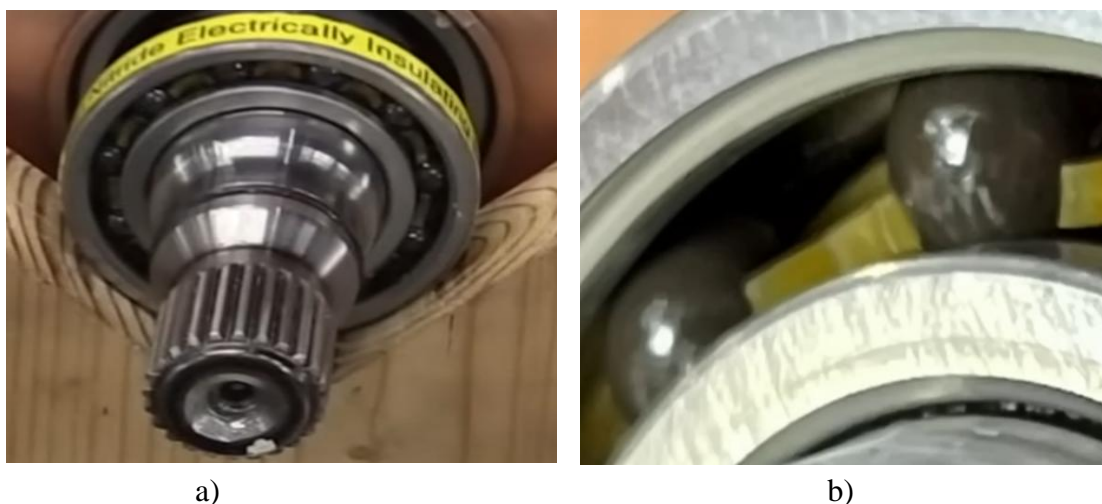
Obrázok 5: a) silikon nitridové ložisko rotora b) detail na guličky ložiska [12].
