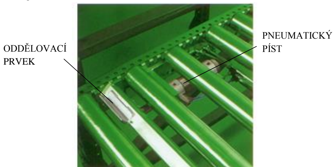
Obr. 2.3 Pneumatické oddělovací zařízení palet firmy Rollex CZECH s.r.o. [2]
