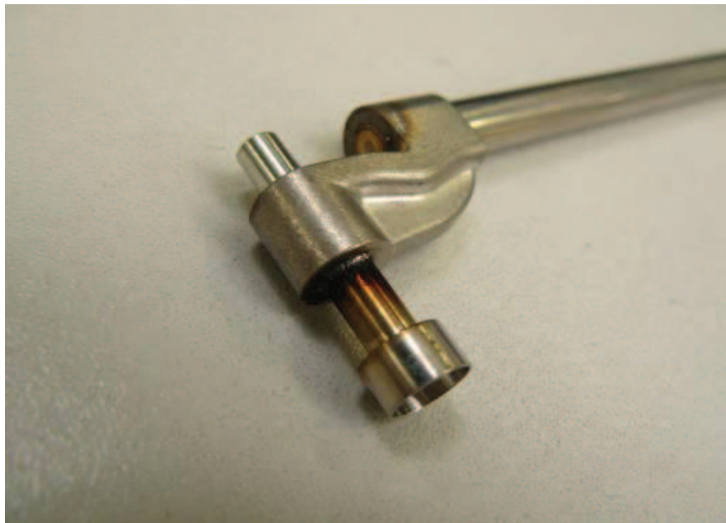
Obr. 11: Materiál po svařování
