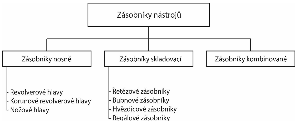
Obr. 1) Základní rozdělení zásobníku dle konstrukce
