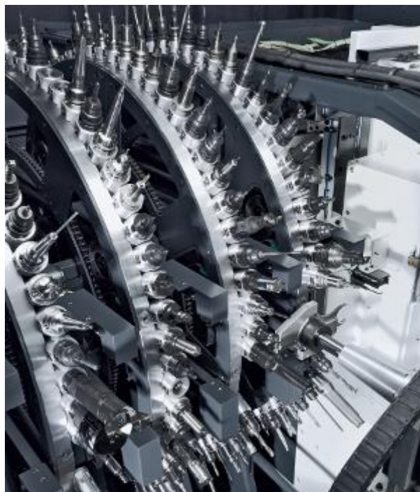
Obr. 11) Příklad zástavby více zásobníkových jednotek [DMG MORI] [16]
