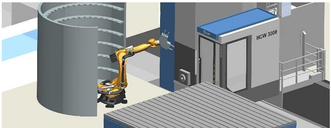
Obr. 14) Koncepce zásobník-manipulátor-vřeteno, manipulátor s dvěma efektory [KUKA] [18]
