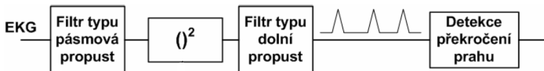
Obr. 22: Blokové schéma detektoru založeného na filtraci
