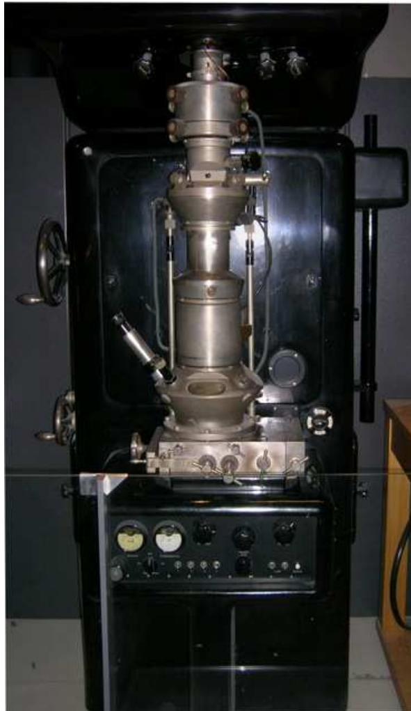
Obr. 3.2: Elektronový mikroskop sestavený E. Ruskou v roce 1933 [5].
