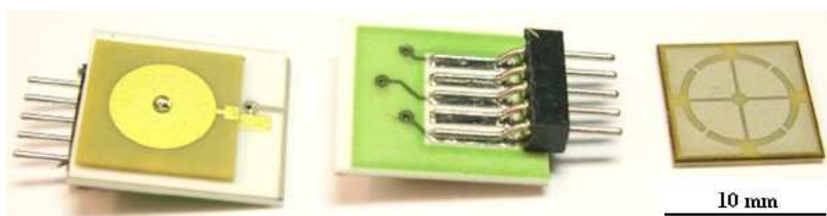
Obr. 8.55: Piezoelektrické pohony typu „push-pul“ [35].
