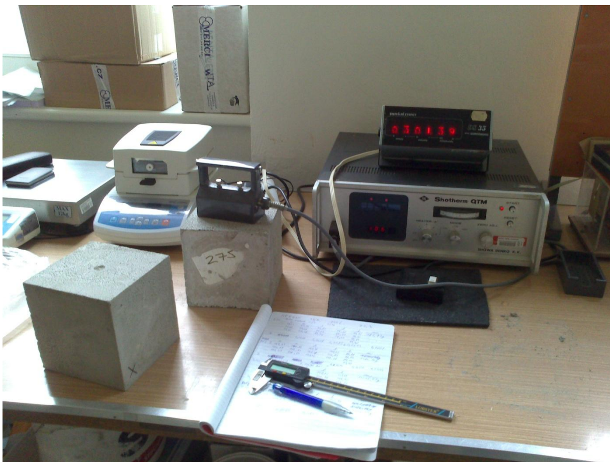
Obr. 14 Měření součinitele tepelné vodivosti na přístroji Shotherm QTM
