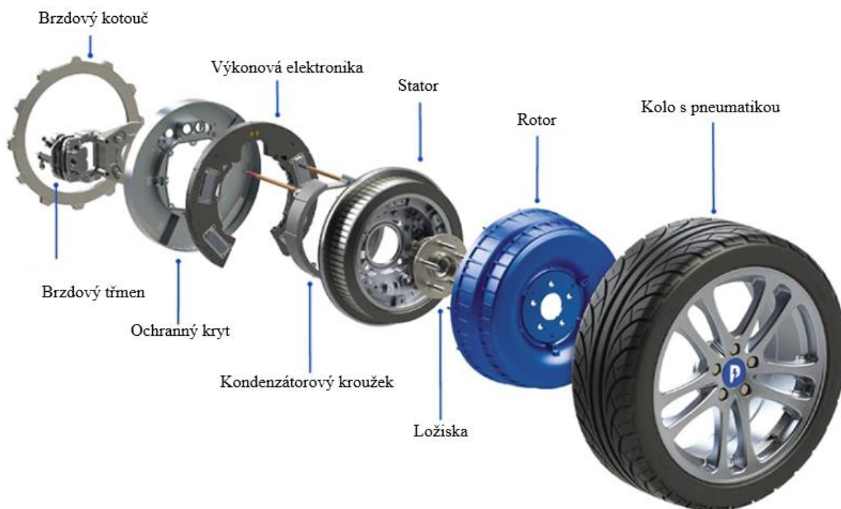
Obr. 15 Rozložený „in-wheel“ motor [25]
