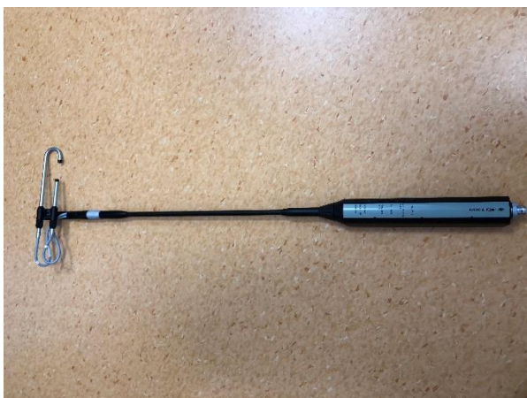
Obr. 22 Intenzitní sonda Brüel & Kjær
