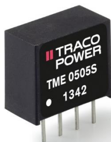
Obrázek 29 - DC/DC měnič pro napájení izolovaného I2S rozhraní
