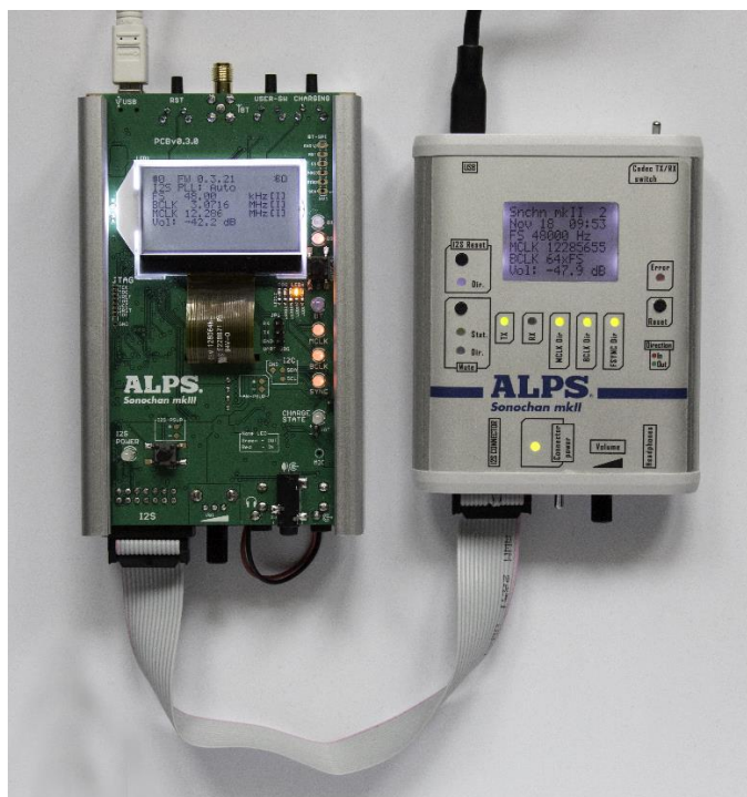
Obrázek 45 – Ukázka zapojení při ověření základní funkčnosti zvukové karty
