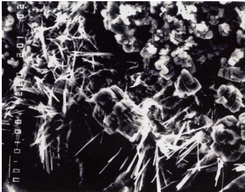
Obr. 5: Ošetřený beton 50mm pod povrchem - začátek růstu krystalů z hydroxidu vápenatého do C-S-H gelu
