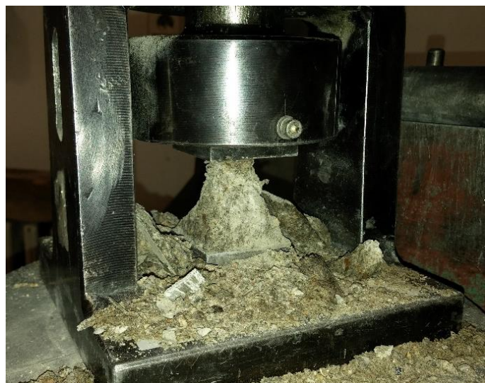
Obrázky 20 a 21: Provádění zkoušky pevnosti v tlaku
