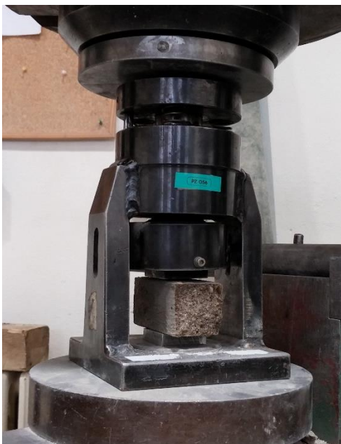
Obrázky 20 a 21: Provádění zkoušky pevnosti v tlaku
