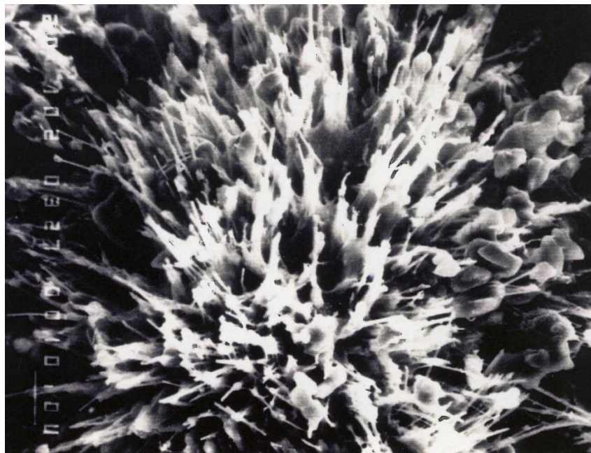
Obr. 6: Ošetřený beton 50mm pod povrchem - tři týdny po aplikaci Xypex concentrate
