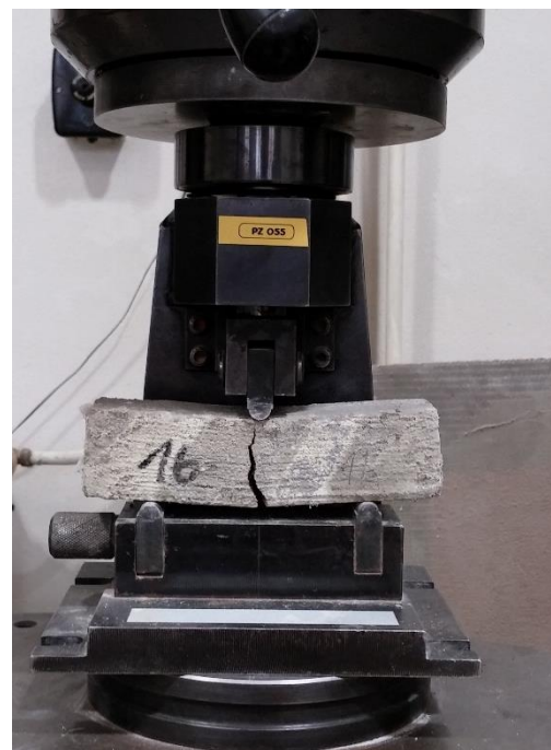
Obrázky 17 a 18: Provádění zkoušky pevnosti v tahu za ohybu
