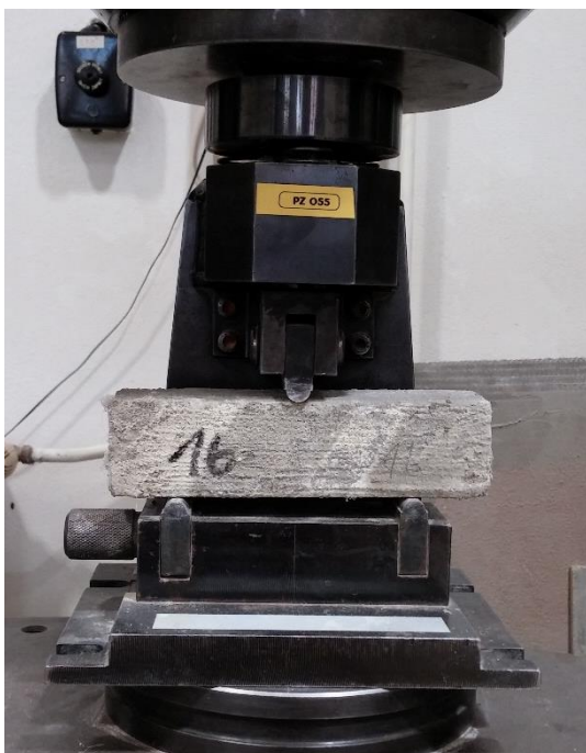
Obrázky 17 a 18: Provádění zkoušky pevnosti v tahu za ohybu
