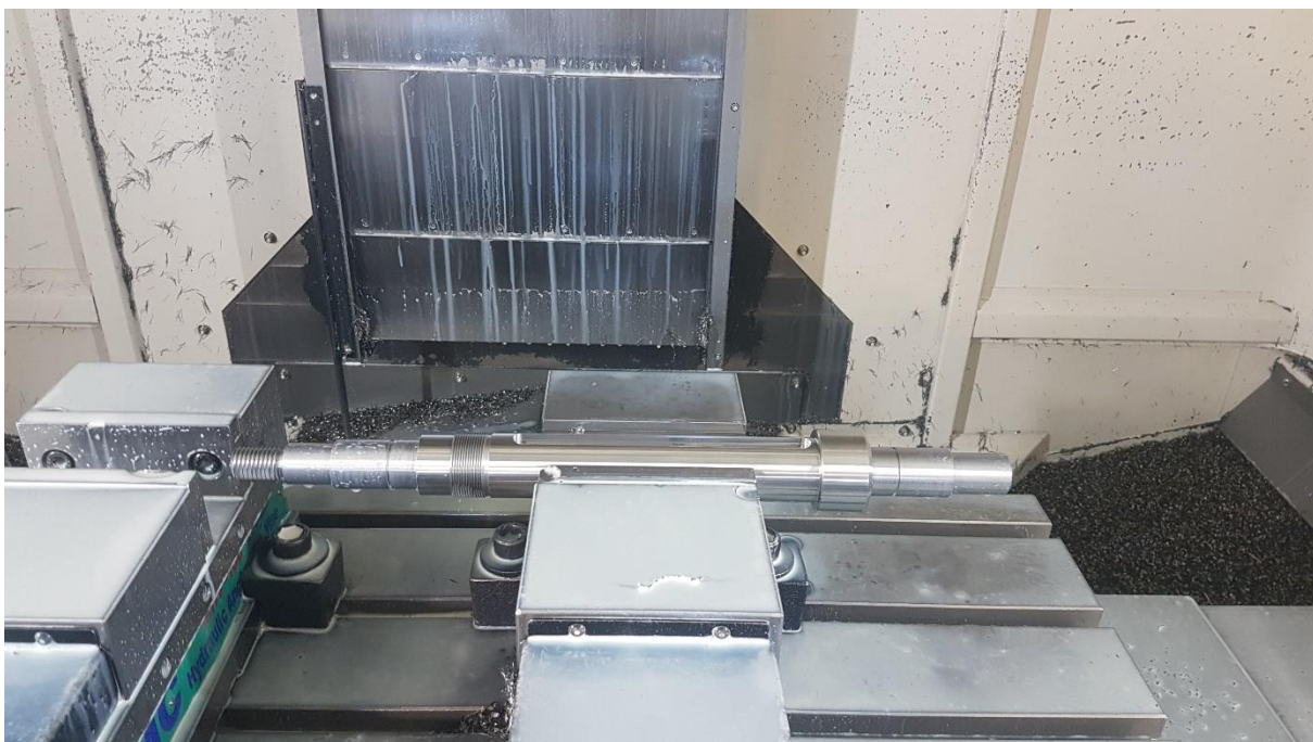
Obr. 6.16. Vyfrézovaná drážka 12 P9.
