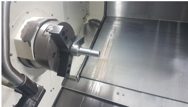
Obr. 6.12. Dokončená pravá strana hriadeľa.
