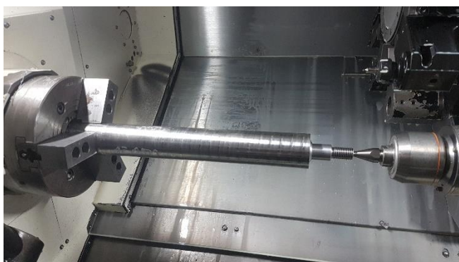
Obr. 6.3. Vysunuté čelo a prisunutý koník.
