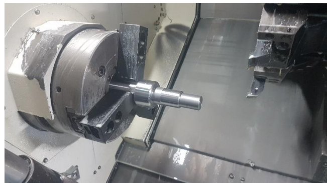
Obr. 6.11. Dokončovacie sústruženie pravej strany.
