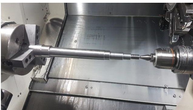
Obr. 6.6. Hriadel' po dokončovacom sústružení.
