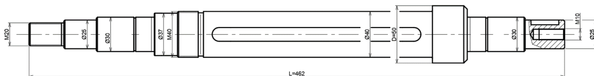
Obr. 3.1. Tvar navrhnutého hriadeľa so zakótovanou celkovou dĺžkou, základnými priemermi a závitmi [vlastný obrázok].
