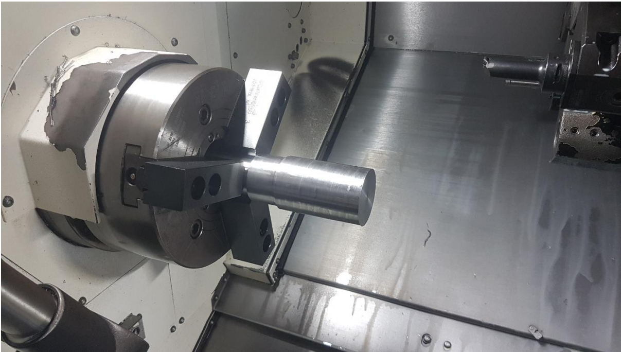
Obr. 6.9. Upnutie v čeľustiach pre výrobu pravej strany.
