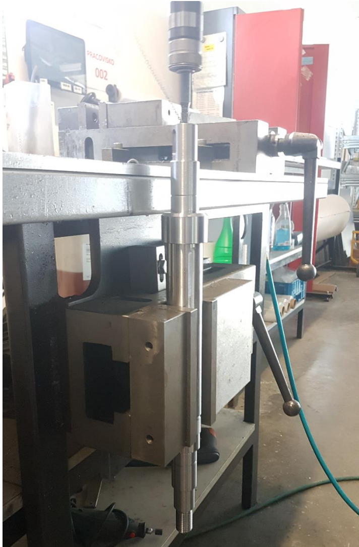
Obr. 6.19. Upnutie hriadeľa a rezanie závitú M10-6H.
