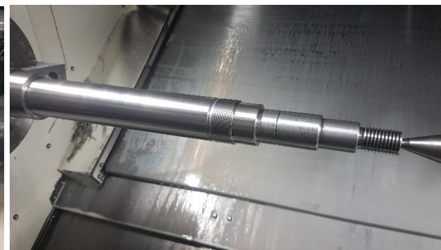
Obr. 6.7. Vyhotovený ľavý vonkajší závit M40x1,5-6g LH.
