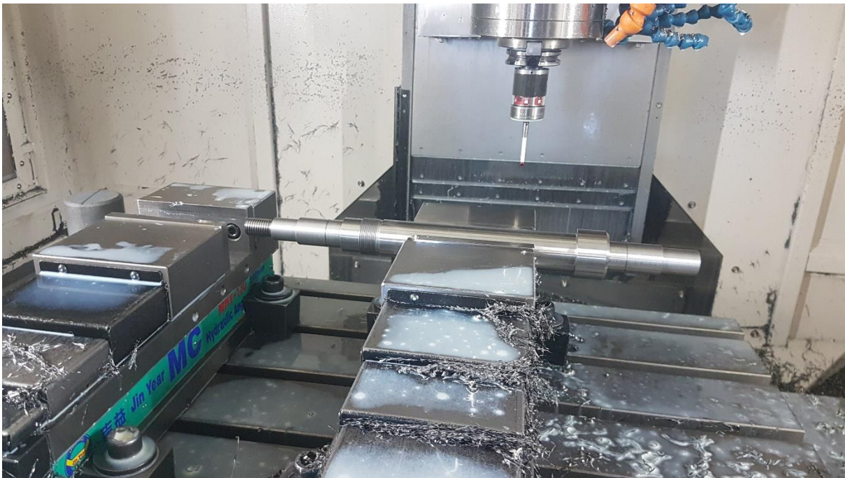
Obr. 6.15. Upnutý hriadeľ pripravený na frézovanie.
