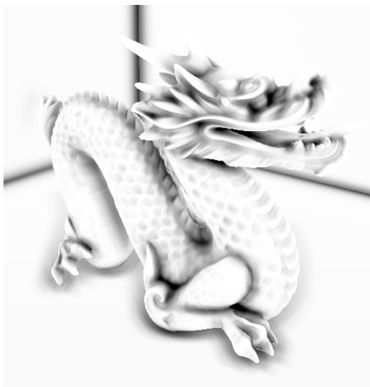
Obrázek 4.7: Ukázka vypočteného zastiňovacího faktoru s řešeným problémem záře
