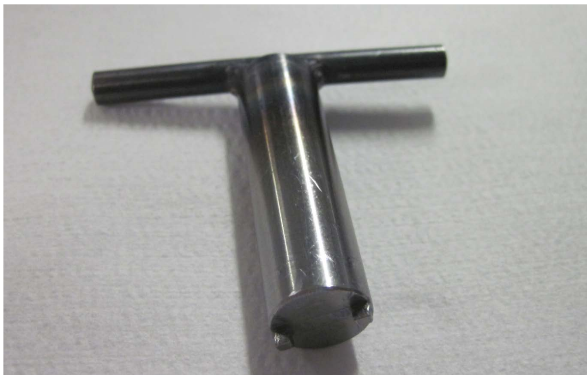
Obr. 3. 7 Pomocný přípravek pro dotažení vnitřního pojistného dílu.
