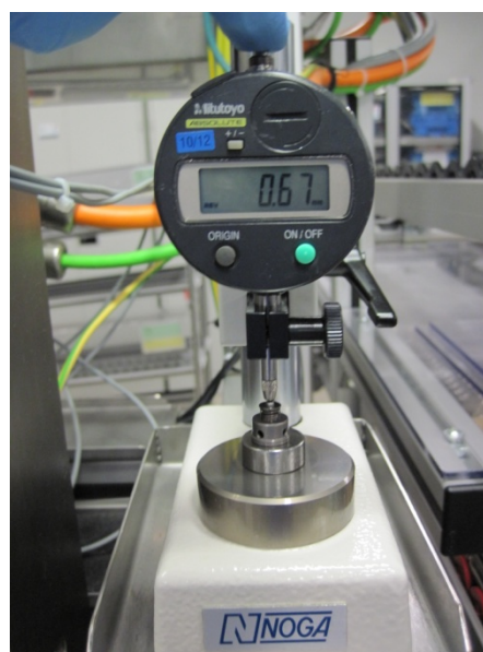
Obr. 2. 13 Měření zdvihu sacího ventilu 2 .
