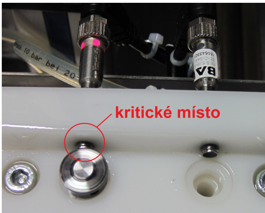
Obr. 3. 9 Umístění indukčního snímače Balluff v odsávacím přípravku.
