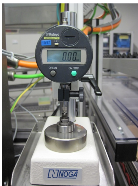
Obr. 2. 12 Digitální úchylkoměr Mitutoyo 2 .
