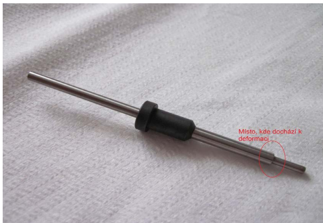
Obr. 3. 1 Stávající geometrie lisovacího a vodicího trnu 2 .
