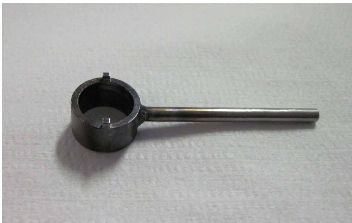
Obr. 3. 6 Pomocný přípravek pro fixaci pozice vodícího pouzdra.
