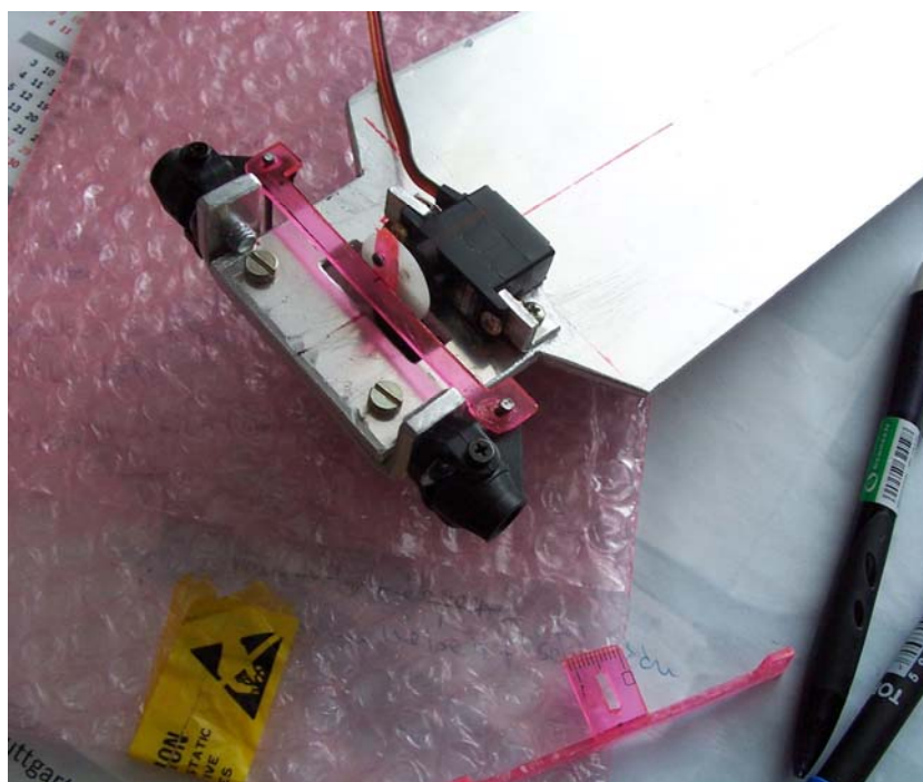
Obr. 3.3.1c: Umístění serva na rámu vozidla (spolu s testovací verzí tyče řízení)
