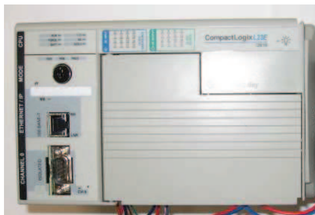
Obrázek 2.2: Technický popis CompactLogix 1769-L23E-QB1B [5]
